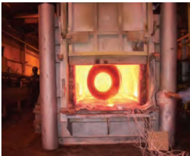
شکل ۲-۴- کوره عملیاتی حرارتی
