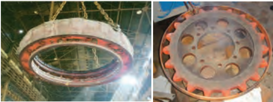
شکل ۳-۴- عملیات حرارتی سخت‌کاری سطح چرخ‌دنده بزرگ فولادی
