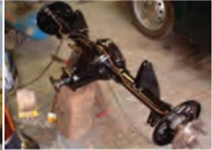
الف) اکسل عقب و دیفرانسیل اتومبیل
