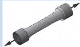
شکل ۱۶-۳- نمونه تست کشش طبق استاندارد ASTM A۳۷۰
