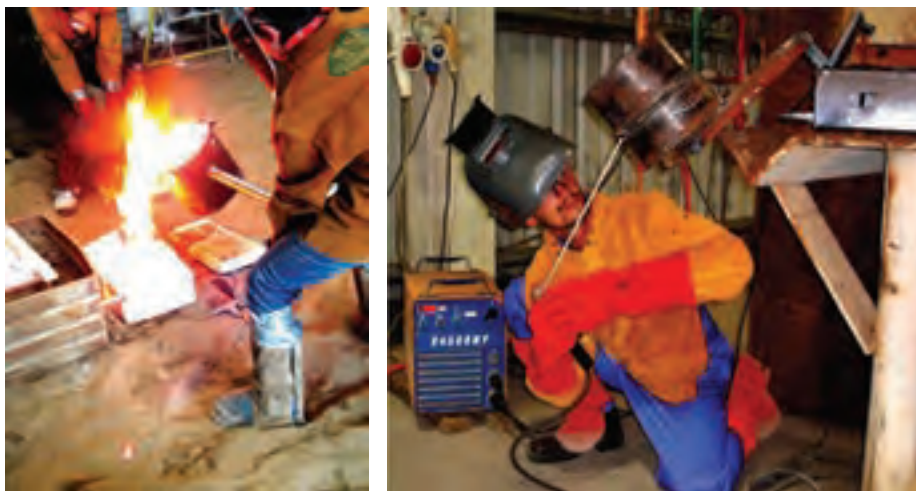
شکل ۳-۱۴ ذوب ریزی درون قالب ریخته گری
