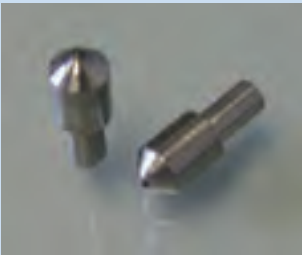
شکل ۲۱-۳- نمونه‌ای ابزار فرورونده جهت اندازه‌گیری سختی
