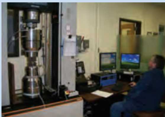
شکل ۲۳-۳- آزمایش اندازه‌گیری مقاومت نمونه در برابر شکست خستگی
