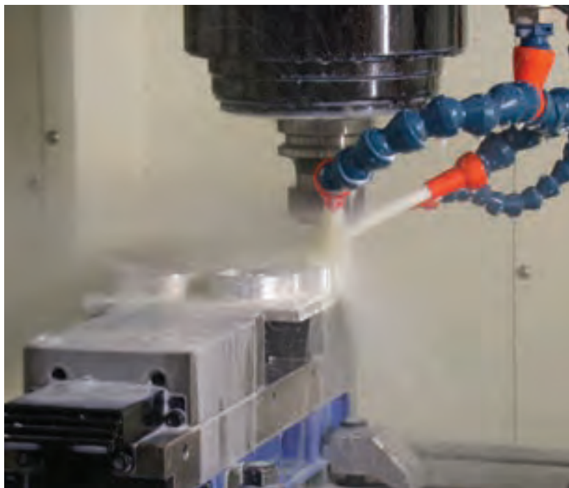
شکل ۳-۱۵ عملیات ماشین کاری قطعه فولادی
