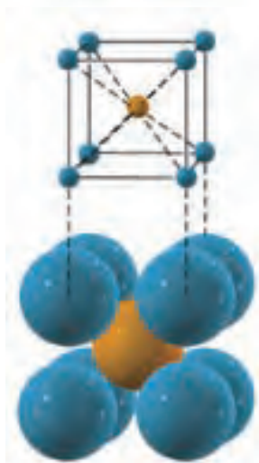
شکل ۳-۶- شبکه کریستالی مکعبی مرکز بر
