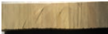
شکل ۴-۸- ج) - نمونه چوبی با الیافی عمود بر جهت طولی (عمود بر الیاف)
