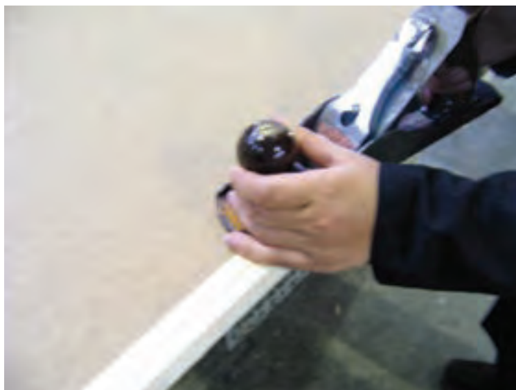
شکل ۱۹ - هم سطح کردن لبه‌ی اضافی زهوار با سطح نئوپان
