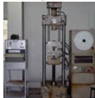
شکل ۶-۱۵- دستگاه کشش و فشار با سیستم مکانیکی (انواع قدیمی‌تر) را نشان می‌دهد. ترسیم گراف و تنظیم دستگاه به وسیله ادوات مکانیکی بدون استفاده از کامپیوتر است.
