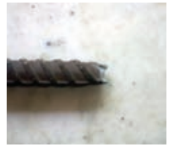
شکل ۶-۲۲ میلۀ گرد فولادی گسیخته شده پس از انجام آزمایش کشش
