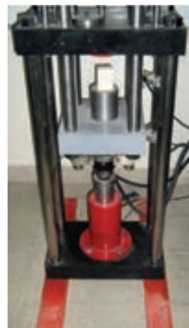
شکل ۶-۱۴- دستگاه کشش و فشار هیدرولیکی، ظرفیت این دستگاه حدود ۱۵ تن بوده و حرکت آن به وسیله جک هیدرولیک ایجاد می‌شود بخش فوقانی جک هیدرولیک که با فلش نشان داده شده است نیروسنج می‌باشد.
