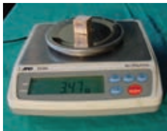
شکل ۱۶-۳ (ب) - ترازوی دیجیتالی توزین نمونه چوب
