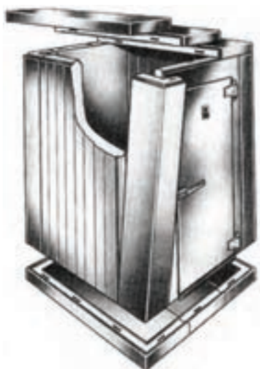
شکل ۲۱-۱۰- اتاق سرد جازدنی - که در محل قابل مونتاژ است. پنل‌ها از فوم با فلز در هرسو ساخته شده‌اند. این جعبه پیش ساخته می‌تواند در بیرون یا داخل قرار گیرد.
