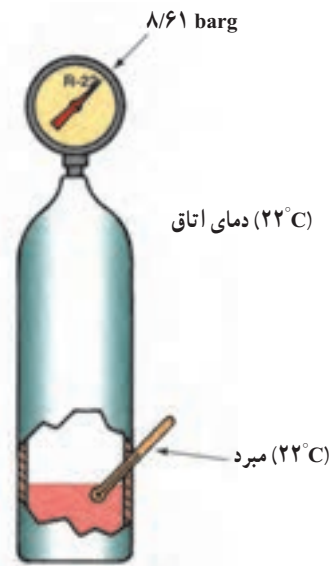
شکل ۲-۱۳ در دمای 22^{\circ}\text{C} فشارسنج فشار 8/61 \text{ barg} را نشان می دهد.
