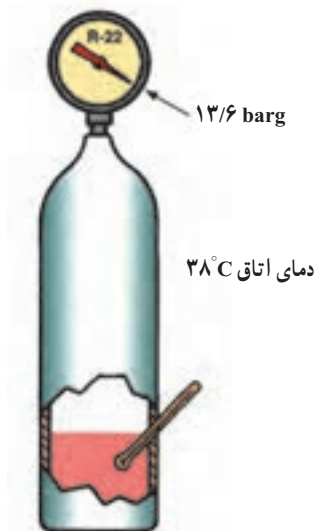
شکل ۲-۱۵ در دمای 38^{\circ}\text{C} فشار نسبی 13/6 \text{ barg} است.
