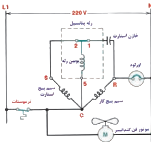
شکل ۸-۱- مدار الکتریکی آب سردکن
