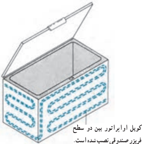
شکل ۶-۶ اوپراتور صفحه‌ای در دستگاه فریزر صندوقی
