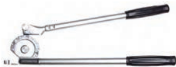
شکل ۱-۳۴- اجزای لوله خم کن اهرمی
