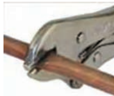
شکل ۱-۳۷- کورکن لوله مسی از نوع انبر قفلی و طریقه‌ی کار با آن
