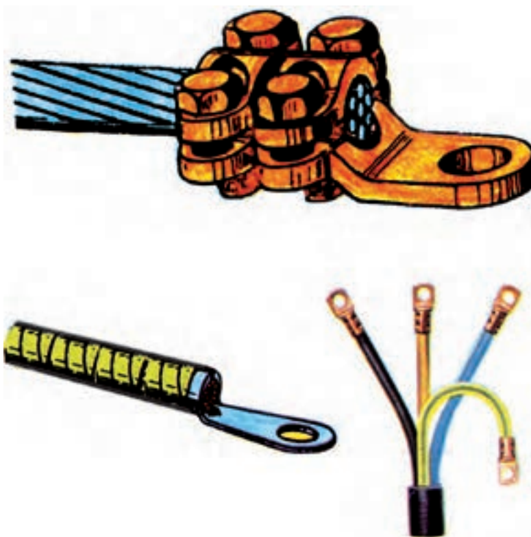
شکل ۴-۴ سه روش اتصال کابل شو به کابل
