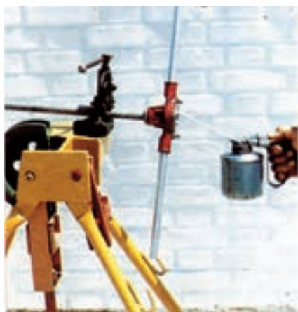
روغن زدن حین حدیده کاری
