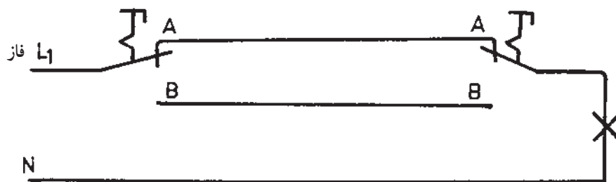
شکل ۲۳-۵- چگونگی ارتباط دو کلید با یکدیگر
