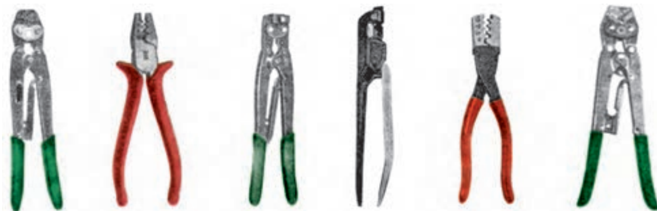
شکل ۲۰-۲ - الف - انواع پرس های دستی
