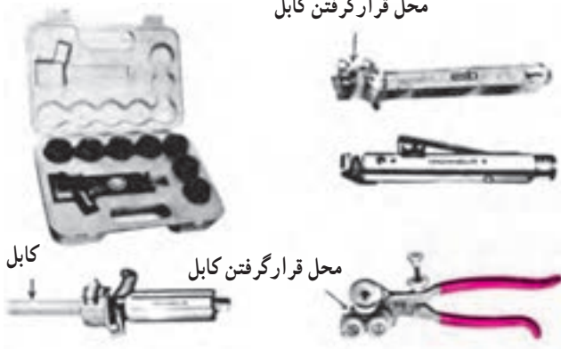
شکل ۱۷-۲ دستگاه روکش‌برداری کابل
