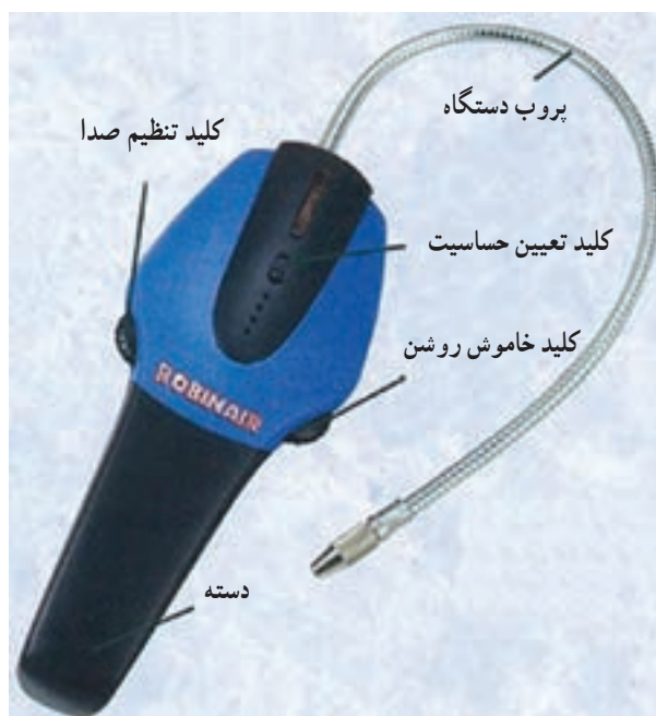
شکل ۲۰-۴- اجزای نشت یاب الکترونیکی
