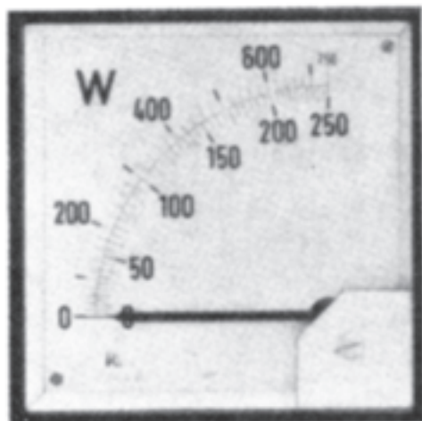
شکل ۲۰-۷- دو نمونه وات متر تابلویی
