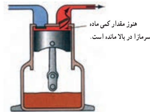
شکل ۳-۷- پیستون در نقطه مرگ بالا
