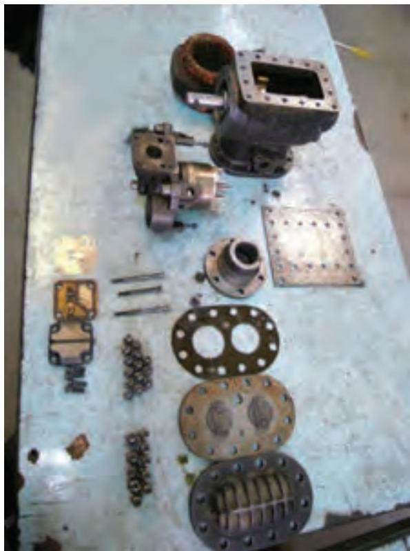
۳۴- در شکل زیر اجزای یک نوع کمپرسور باز شده
