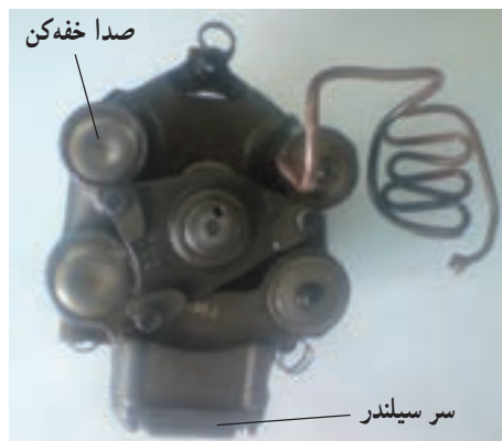
شکل ۲-۹- صدا خفه‌کن درون کمپرسور تناوبی بسته و صدا خفه‌کن قابل نصب بر روی لوله‌ی رانش
