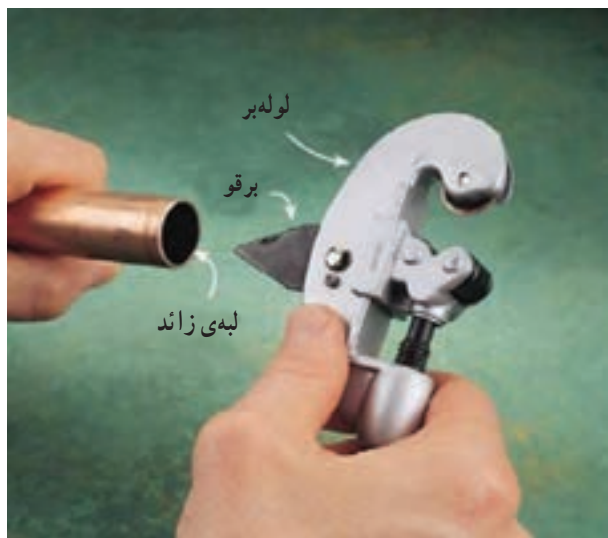
شکل ۱۵-۱- لوله‌بر با برقو مخصوص لوله‌ی مسی
