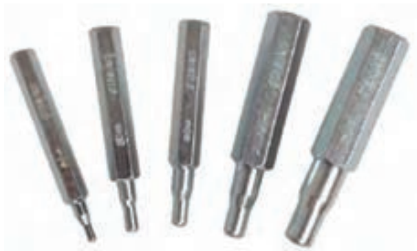
شکل ۱-۲۱- چند نوع سنبه‌ی گشادکن
