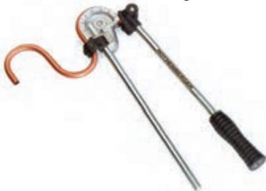
شکل ۱-۳۳- لوله خم‌کن اهرمی
