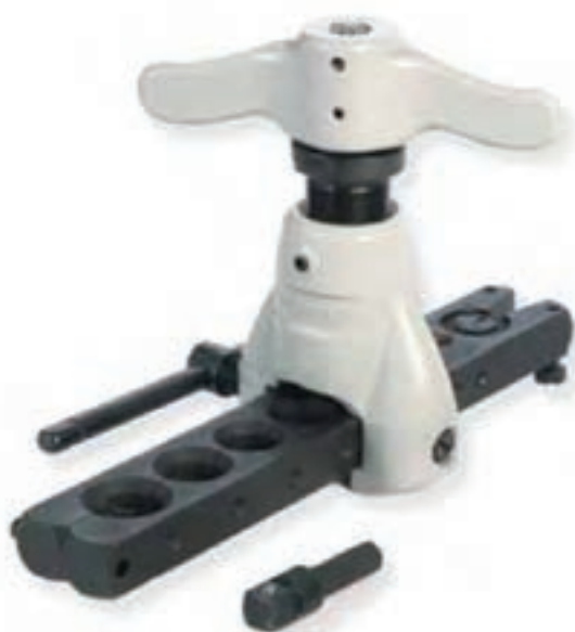
شکل ۱-۱۸- چند نوع لاله‌کن لوله‌ی مسی
