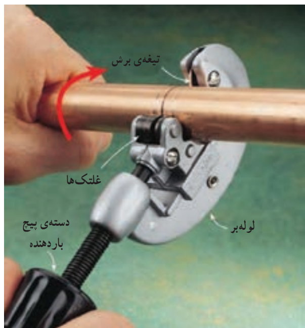
شکل ۱۱-۱- طریقه‌ی بریدن لوله‌ی مسی با لوله‌بر
