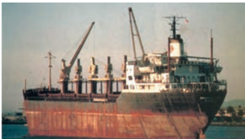
زنگ زدگی در یک کشتی
