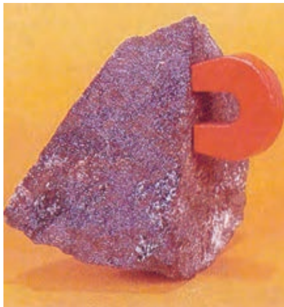
شکل ۵-۷ کاتالیزگر آمونیاک متشکل از کانی حاوی آهن اکسید
