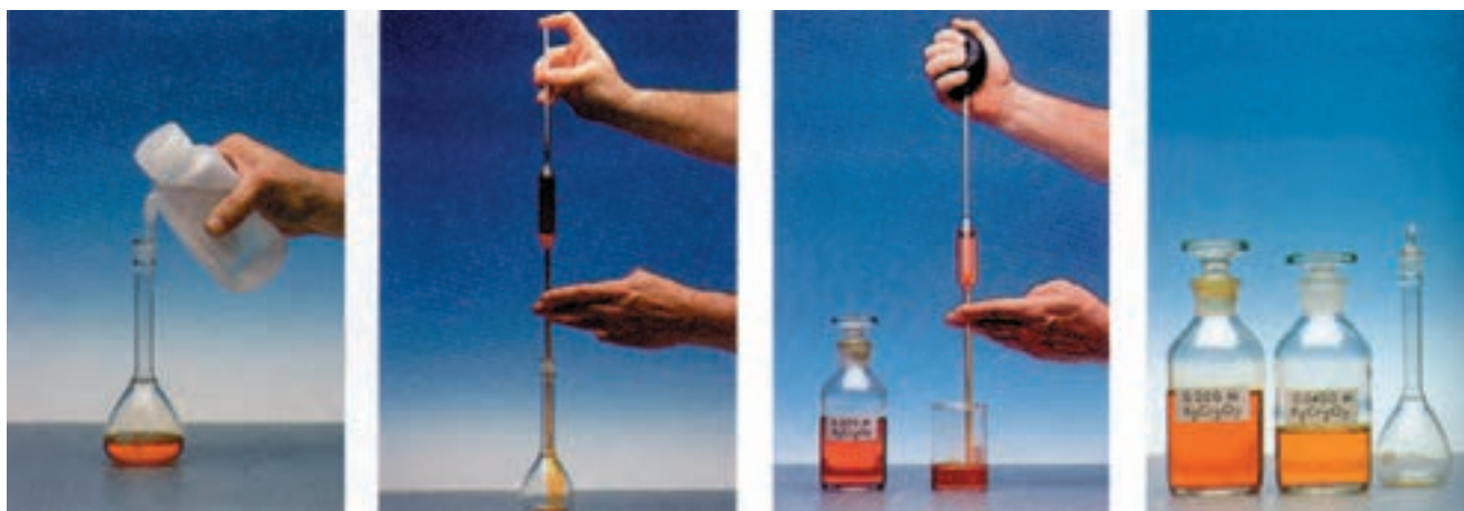
شکل ۱-۱۰- تهیهی محلول ۰/۱N پتاسیم دی کرومات از محلول ۱N آن
