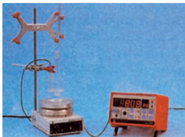
شکل ۴-۱۵ اندازه‌گیری pH به وسیله‌ی دستگاه pH سنج
