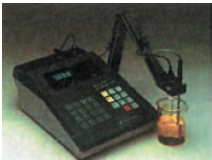
تعیین pH یک محلول به وسیله‌ی دستگاه pH سنج
