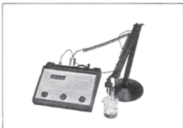
شکل ۲-۱۵ دو نوع pH سنج با دقت 0.01 \text{ pH} .
