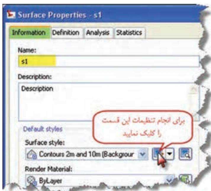
پنجره Surface Style باز می‌شود. این پنجره دارای دو قسمت آن را توضیح می‌دهیم. در برگه Display می‌توان مشخص نمود چه مواردی با چه رنگی نمایش داده شود. این موارد شامل نقاط، مثلث بنده، خط محدوده، منحنی های فرعی و اصلی و .... می‌باشد. مطابق شکل می‌توانید تنظیمات لازم را انجام دهید.
