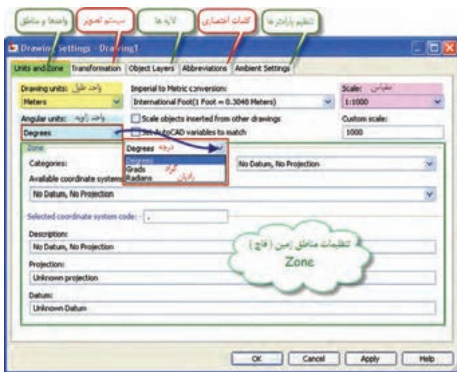
برای تنظیم دیگر واحدها و پارامترها در صفحه تنظیم پارامترها (Ambient Settings) مانند شکل برای مثال تنظیم واحد مساحت اقدام می‌نماییم.
