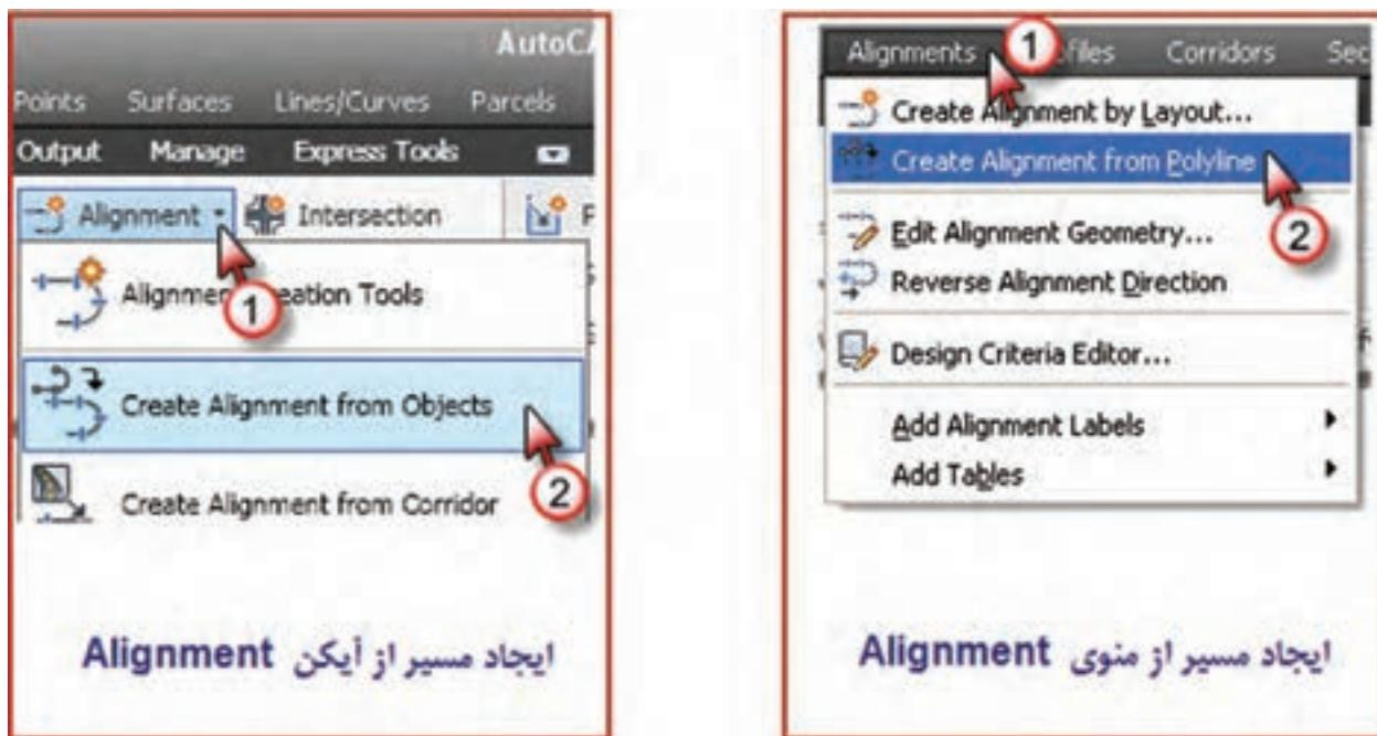
پس از آن روی خط ترسیم شده کلیک کرده و دو بار ایتر می‌نماییم. تا پنجره بعدی باز شود. در این پنجره نامی برای مسیر انتخاب کرده و آنرا Ok می‌نماییم.
