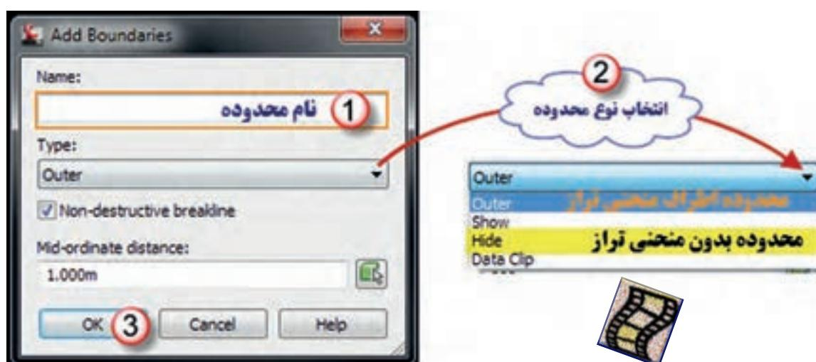
برای خطوط شکستگی (Breaklines) مثل آبراه‌ها و یال‌ها، مانند خطوط محدوده Boundaries عمل می‌شود. با این تفاوت که به جای گزینه Boundaries گزینه Breaklines انتخاب می‌گردد.
