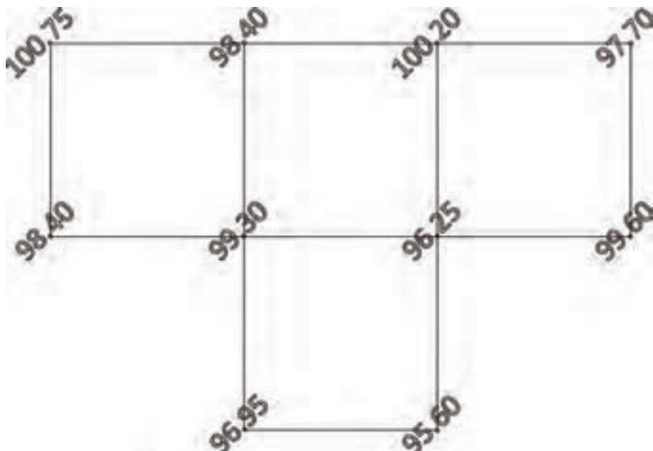
۳ - ابعاد شبکه زیر ۵۰ متری می باشد . مختصات نقاط آن را تنظیم و سپس به Civil 3D انتقال داده و منحنی های یک متری آن را ترسیم نمایید.
