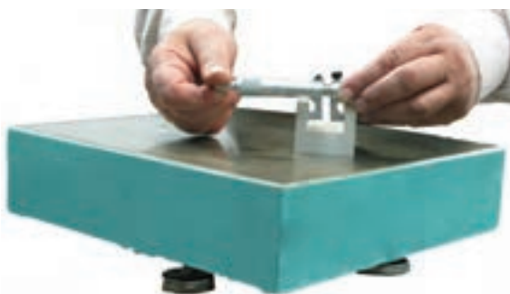
شکل ۶-۵- اندازه‌گیری پهنای شیار قطعه‌ی ناودانی
