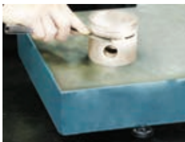
شکل ۵-۸- اندازه‌گیری پیستون توسط فیلر
