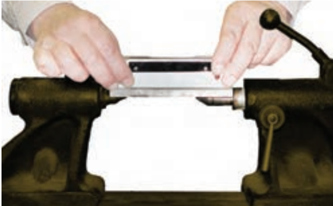
شکل ۵-۲- کنترل هم راستایی محور های دستگاه مرغک
