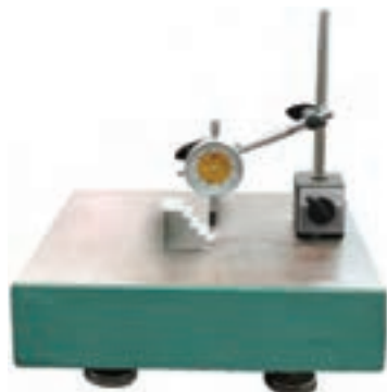
شکل ۱-۶- اندازه‌گیری قطعه‌ی پله‌ای
