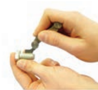
شکل ۱۰-۸- تعیین گام پیچ
