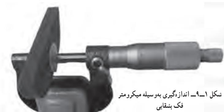
شکل ۹-۱- اندازه گیری به وسیله میکرومتر فک بشقابی
