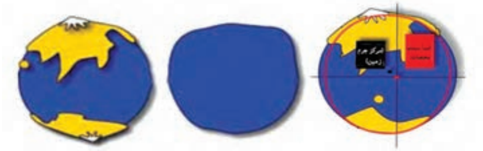
شکل ۳-۴- شکل طبیعی سطح زمین (چپ)، سطح متوسط آبهای آزاد یا ژئوئید به عنوان سطح مبنای ارتفاعی (وسط)، و بیضوی دورانی به عنوان سطح مبنای مسطحاتی (راست)
