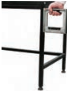
شکل ۲-۲- کنترل شیب پایه‌ی میز
