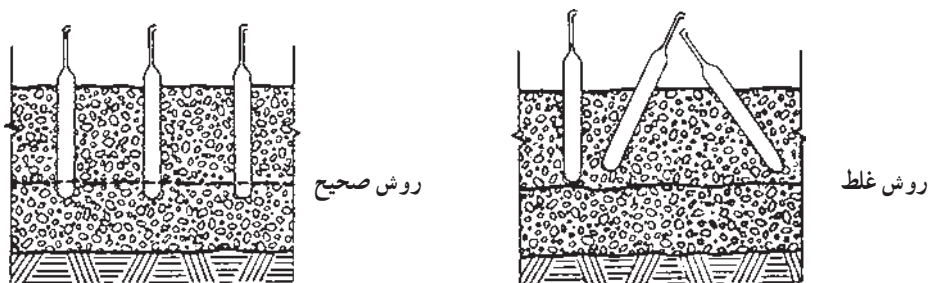
شکل ۶-۱۰- روش قرار دادن لرزانده‌های درونی در داخل بتن
