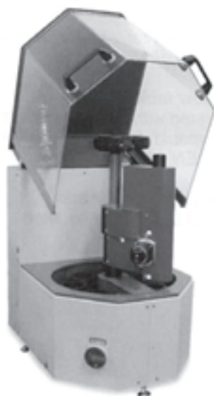
دستگاه ویکات که توسط کامپیوتر کنترل می‌شود و برای تعیین زمان گیرش سیمان مورد استفاده قرار می‌گیرد.
