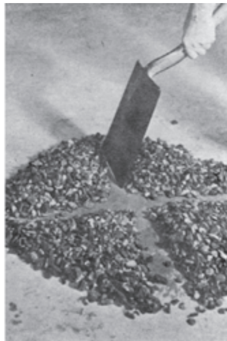
شکل ۲-۴ استفاده از قوطی مقسم برای تقسیم نمونه به طور مکانیکی شکل ۲-۳ روش تربیع برای نمونه برداری مطلوب
