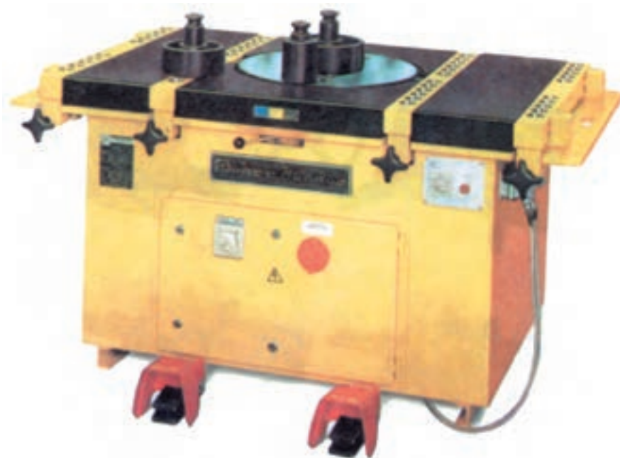
شکل ۲-۶۳ - دستگاه میل گرد خم کن برقی
