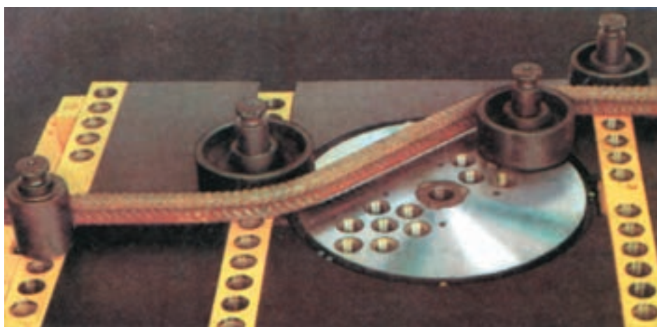
شکل ۲-۶۴ - ساختن اتکا به وسیله ی دستگاه میل گرد خم کن برقی
