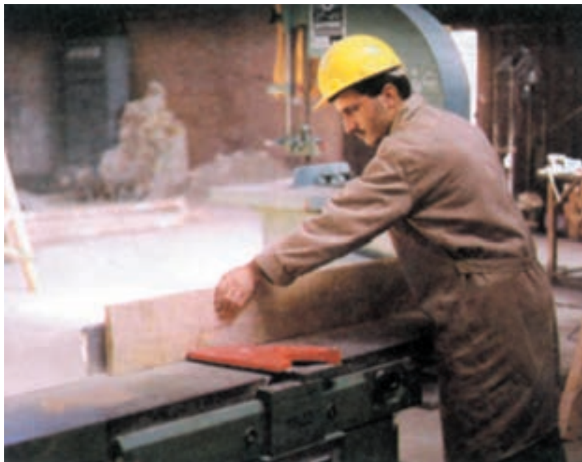
شکل ۱-۷۵- رنده کردن ضخامت (نر) تخته با رنده‌ی برقی
