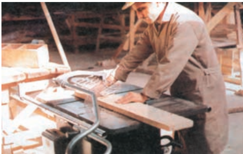
شکل ۱-۶۵- روش بریدن عرضی تخته با ارّه‌ی گرد برقی میزی
