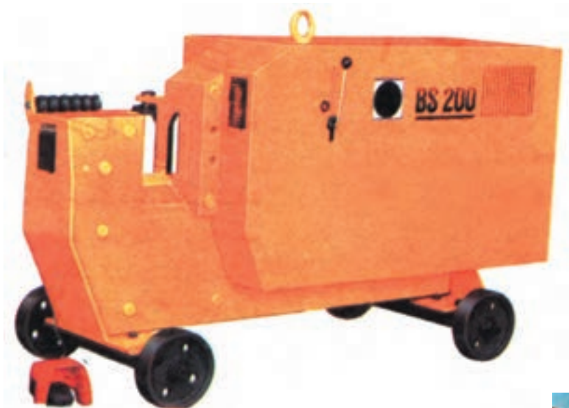
شکل ۵۶-۲ یک نمونه ماشین برقی برش میل گرد
