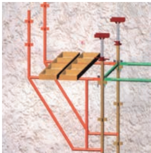
شکل ۷-۴۵- سکوی کار برای داربست فلزی
