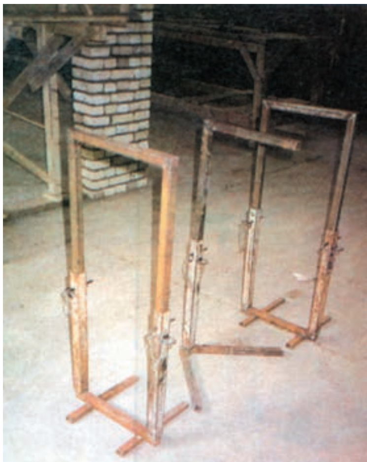
شکل ۹۴-۲- خرک‌های فلزی برای مونتاژ میل‌گرد
