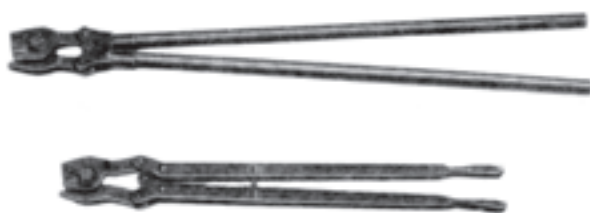
شکل ۵۳-۲ قیچی‌های دستی ساده برای برش میل‌گرد فولادی
