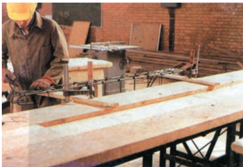
شکل ۹۷-۲- مونتاز میل گرد با استفاده از تخته هایی که با پیچ دستی به میز متصل شده اند.
