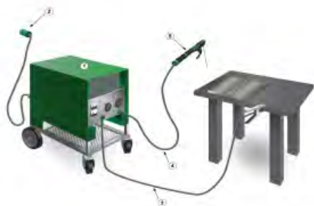
شکل ۴-۴ تجهیزات و دستگاه جوش کاری
