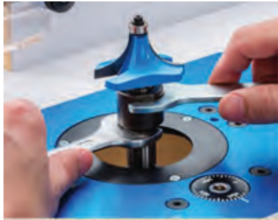
شکل ۱-۲۰۷- قرار دادن تیغه در کولت و محکم کردن آن با آچار
