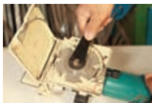
شکل ۱-۱۸۳-ب - روش تعویض تیغه
