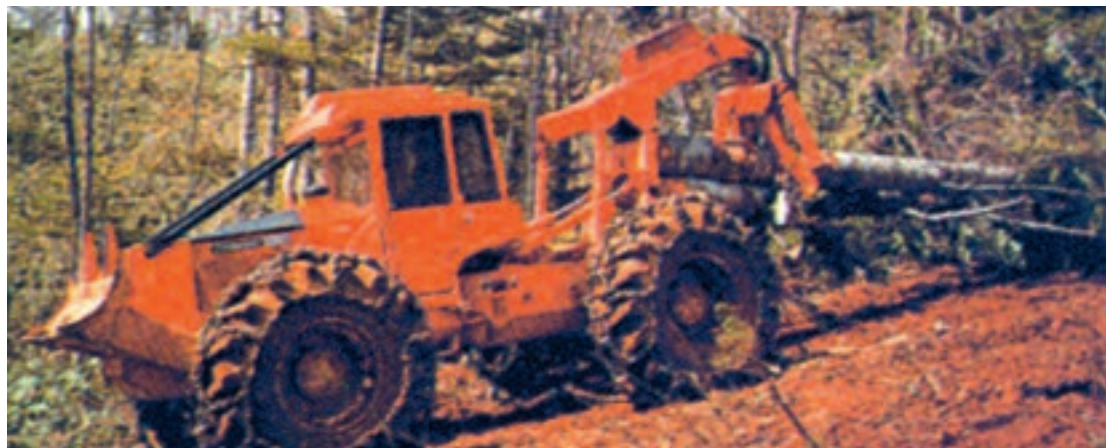
شکل ۱۷-۱- گرده بینه ها به وسیله تراکتورهای چوب کش از جنگل خارج می شوند
