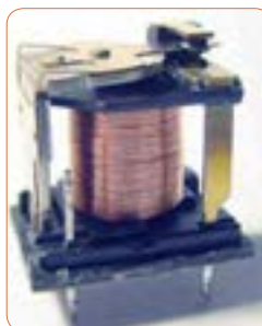
شکل ۳۴-۶ ساختمان داخلی دو نوع رله
