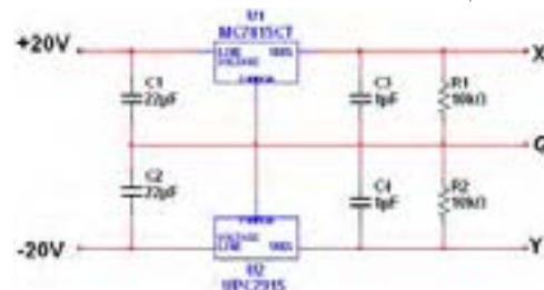
شکل ۶۷-۶ مدار منبع تغذیه متقارن
