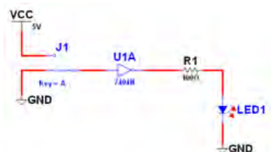
شکل ۵۹-۶ مدار گیت منطقی NOT
