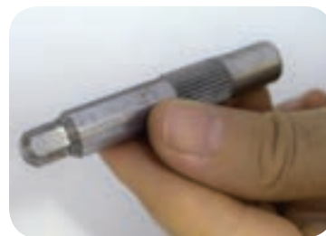
۱ به سطوح تخت چندوجهی (انتهای قطعه) و قسمت آجدار روی قطعه توجه کنید.
