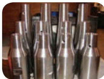
۲ به شکل مخروطی و سطوح تخت روی بدنه استوانه‌ای قطعات توجه کنید.
