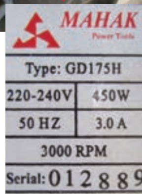
شکل ۴-۵۷ پلاک مشخصات موتور الکتریکی یک نمونه سنگ
