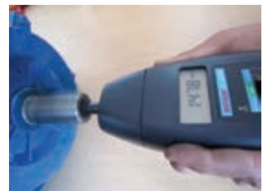
شکل ۴-۲۳ الف نحوه اندازه‌گیری مکانیکی سرعت موتور.
