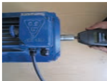
شکل ۴-۲۳ الف نحوه اندازه‌گیری مکانیکی سرعت موتور.
