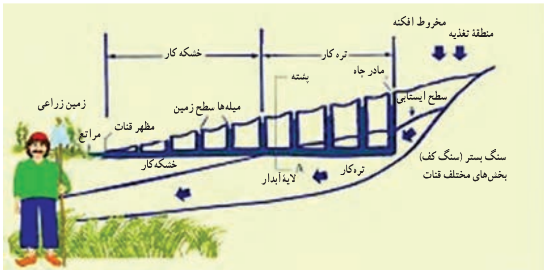
شکل ۳۱-۳- شمای یک قنات
