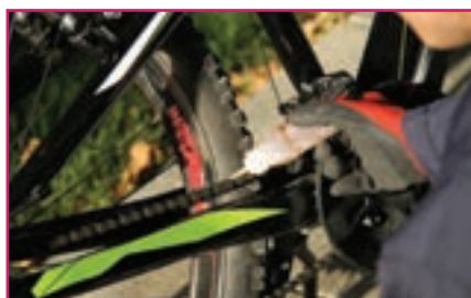
پ- روغن کاری اجزاء
