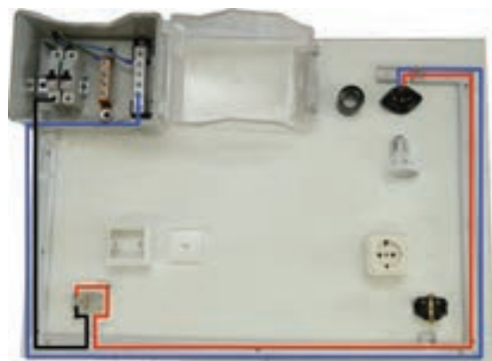
شکل ۸-۵ - انجام سیم کشی روشنایی
