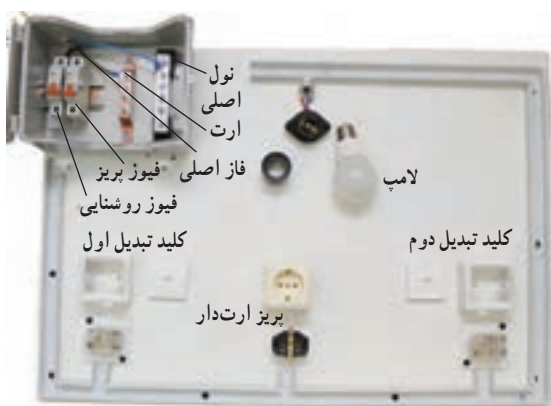
شکل ۵-۲۰- سیم‌کشی کلیدهای تبدیل
