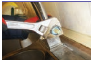
ث- باز کردن پیچ روی مغزی (گلند)
