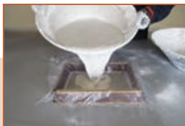
ث - ریختن ملات گچ در قالب
