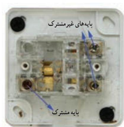
شکل ۵-۱۹- نمای داخلی یک نمونه کلید تبدیل
