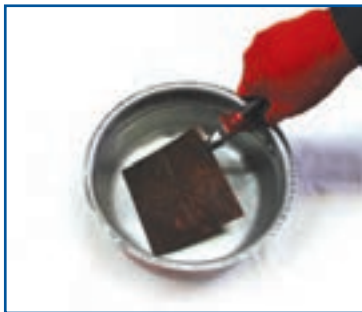
شکل ۹-۱- سرد کردن پلاک مسی با آب
