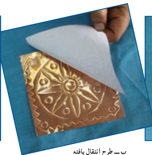
شکل ۴-۱- نحوه انتقال طرح روی ورق مسی
