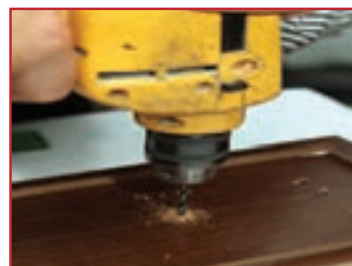
پ- سوراخ کردن در جعبه با دریل
