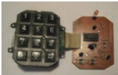
شکل ۹-۴- برد تلفن الکترونیکی و شماره‌گیر
