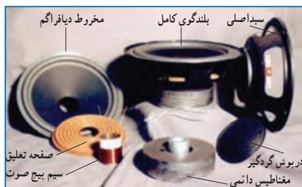
شکل ۹-۲۶ - یک نمونه بلندگو و اجزای باز شده آن
