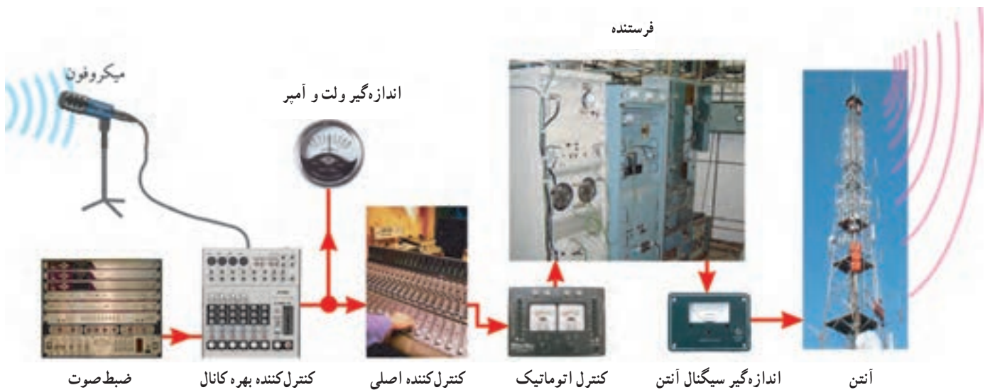
شکل ۱۹-۶- بلوک دیاگرام کلی فرستنده
