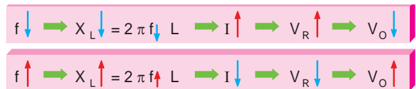
شکل ۴-۶- نمایش تغییرات فرکانس و اثر آن بر روی ولتاژ خروجی
