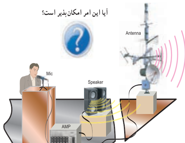
شکل ۷-۳- تبدیل امواج صوتی به امواج الکترومغناطیسی
