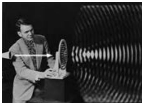
شکل ۲-۳ نحوه انتشار صوت در هوا
