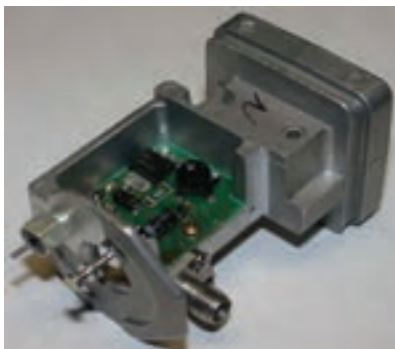
شکل ۲۹-۲ LNB و مدار داخل آن
