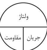
$$\frac{\text{ولتاژ}}{\text{مقاومت}} = \text{جریان}$$
