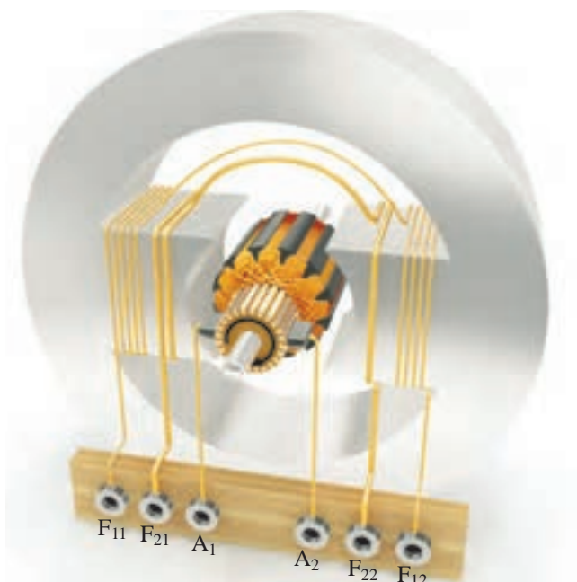
شکل ۳-۳۵ طرح ساختمانی ژنراتور کمپوند
