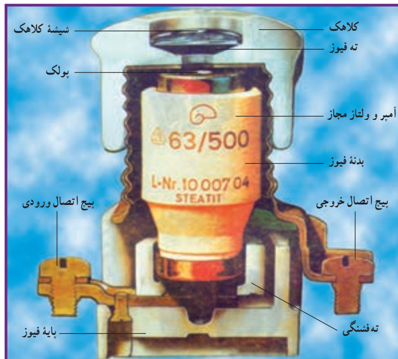
شکل ۱۵-۴- نمای بُرش خورده فیوز فشنگی
