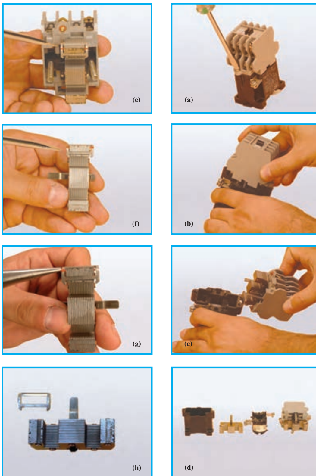
شکل ۳-۴- مراحل باز کردن اجزای تشکیل دهنده کنتاکتور
