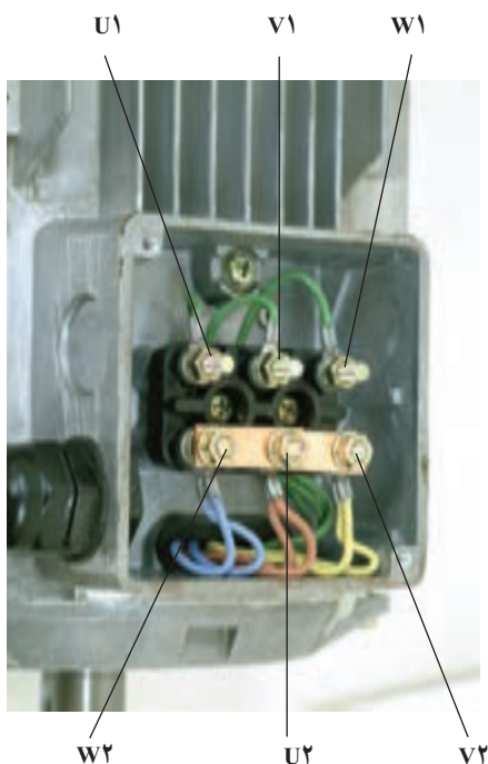
شکل ۱۸-۱- اتصال ستاره روی تخته کلم موتور
