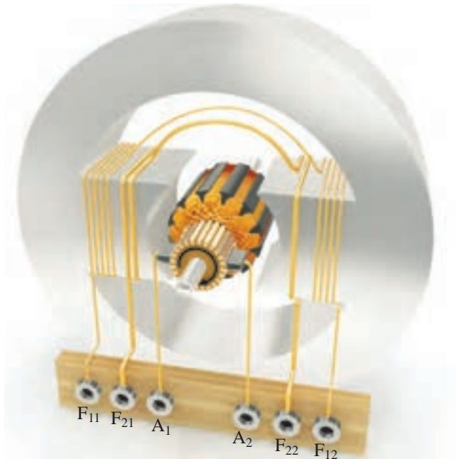
شکل ۳-۳۵ طرح ساختمانی ژنراتور کمپوند
