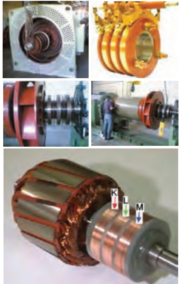
شکل ۸- رتور سیم پیچی شده در ابعاد مختلف
