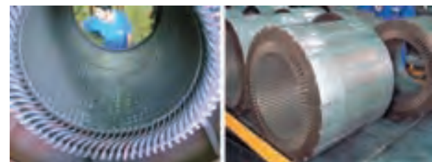
شکل ۳- هسته استاتور، بدنه و سیم پیچ استاتور
