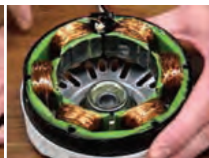
الف) شمای واقعی با ماشین القایی با سیم پیچ متمرکز
