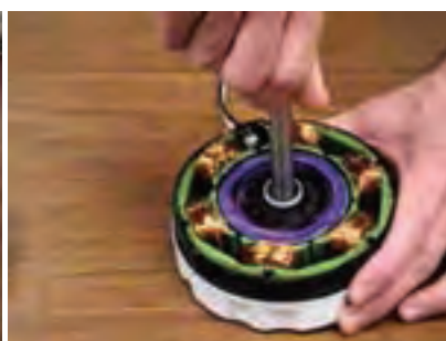
د) شکل واقعی ماشین القایی سیم پیچ متمرکز مدل آزمایشگاهی
