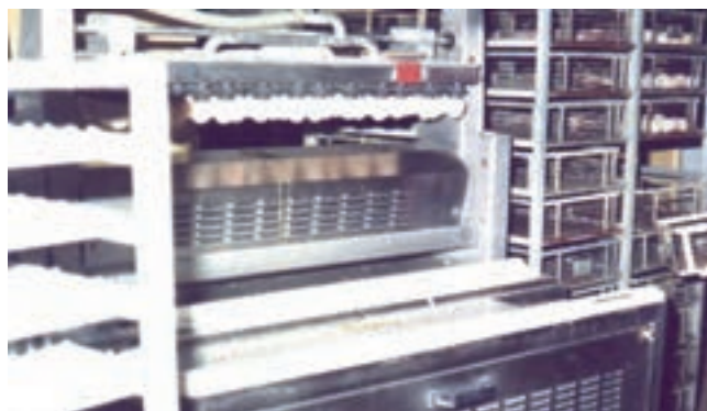
تصویر ۱۱-۴- انتقال تخم مرغ به سبد هجری به روش خودکار (اتوماتیک)
