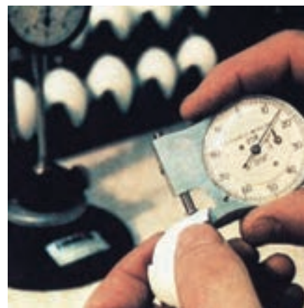
تصویر ۱-۲۵ - اندازه‌گیری ضخامت پوسته با میکرومتر
