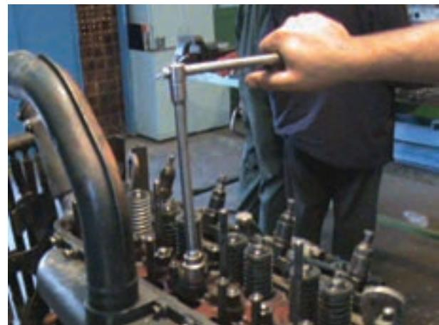
الف) باز کردن پیچ‌های سرسیلندر تراکتور U650
