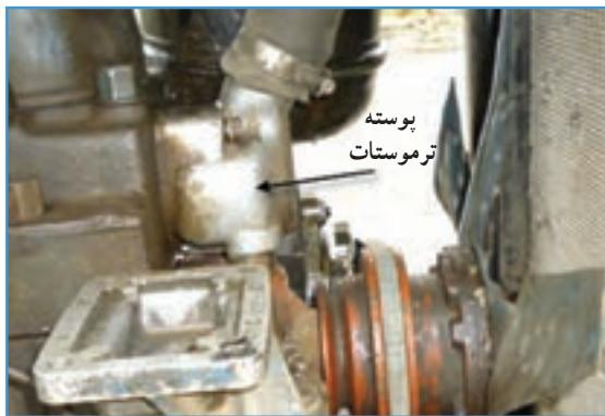
شکل ۲-۳۷—پوسته ترموستات تراکتور U650
