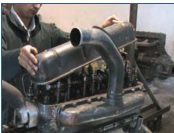
شکل ۷-۴۰- برداشتن قالپاق سوپاپ
