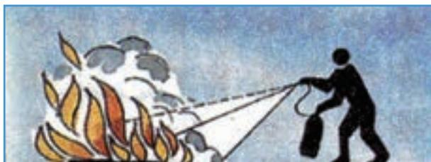
شكل ۱۳— روش خاموش کردن آتش با پودر
