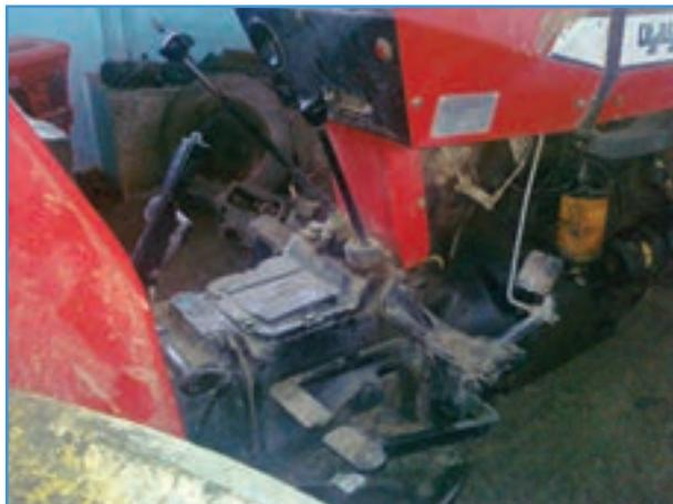
شکل ۲۱-۲۱— اهرم‌های تعویض دنده و دنده کمک
