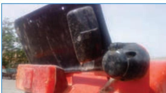
شکل ۲-۱۷- چراغ خطر و ترمز و پریز تریلر تراکتور
