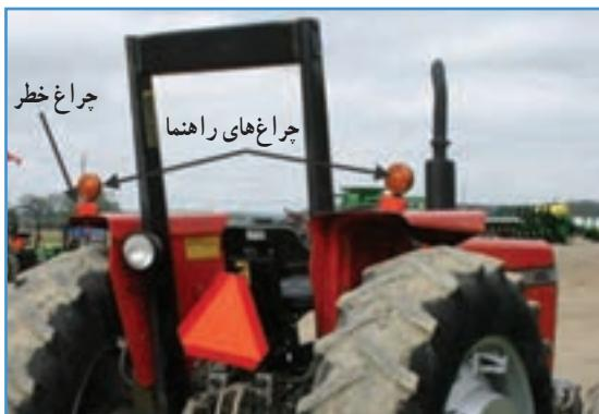
شکل ۲-۱۶- چراغ راهنمایی تراکتور MF285
