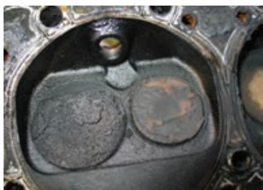
الف) تمیز کردن سطح سرسیلندر با برس سیمی
