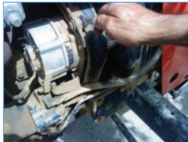
شکل ۶-۲۹— شل کردن پیچ و مهره تنظیم
