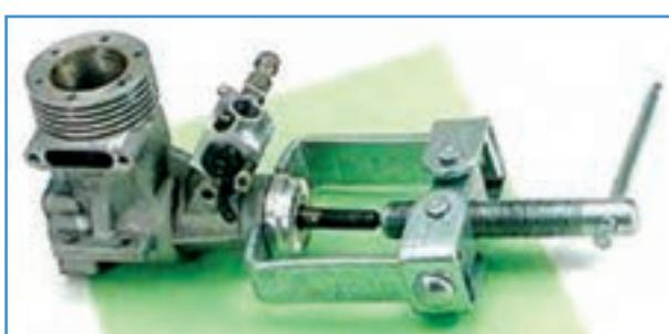
شكل ۳-۷۷- خارج کردن بلبرینگ با بلبرینگ کش
