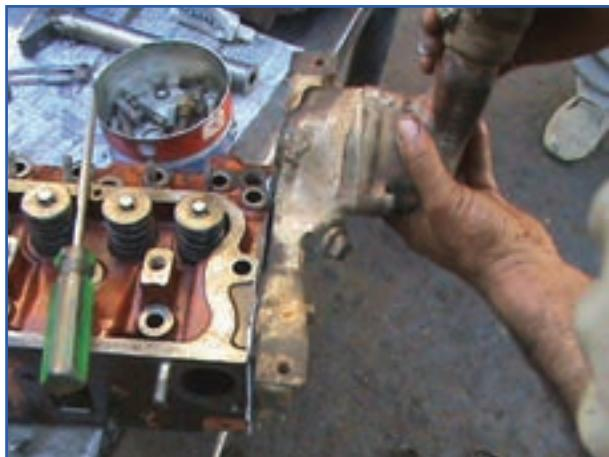
ب) باز کردن محفظه ترموستات تراکتور MF399
