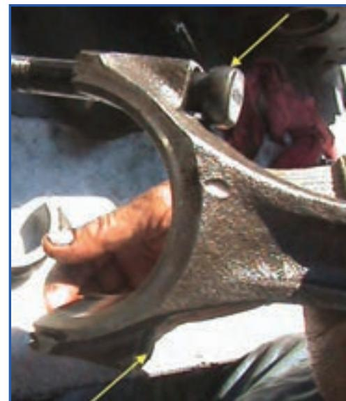
شکل ۸۵-۴- خارج کردن پیچ شاتون
