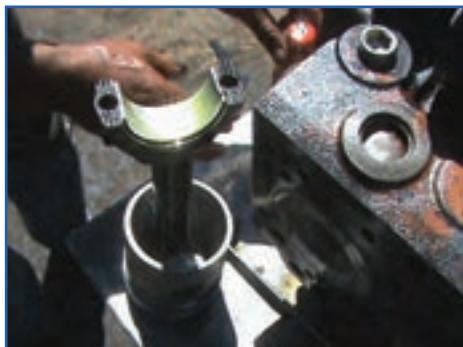
شکل ۱۹۲-۴- روغن کاری رینگ ها، پیستون و یاتاقان
