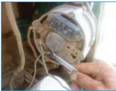
شکل ۳۵-۶- بستن سیم نازک
