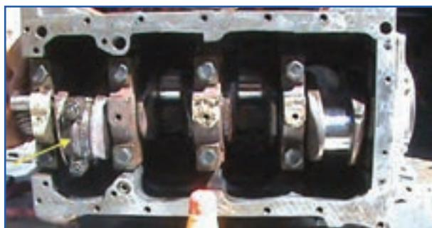
شکل ۸۳-۴- وضعیت میل لنگ برای باز کردن پیچ های شاتون
