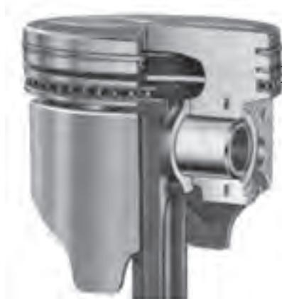
شکل ۲-۲۲— انواع رینگ روی پیستون
