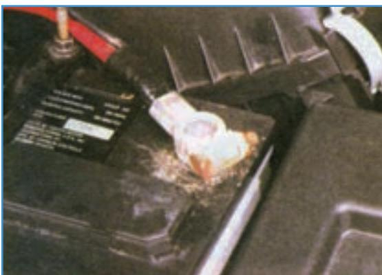
شکل ۲۱-۶— سولفاته کردن بست مثبت باتری
