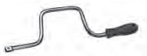
شکل ۳-۴۵— دسته بکس هندلی
