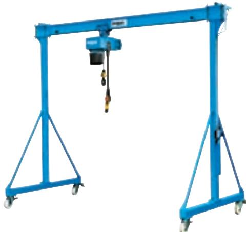
شکل ۴-۲۳—جرثقیل دروازه‌ای متحرک
