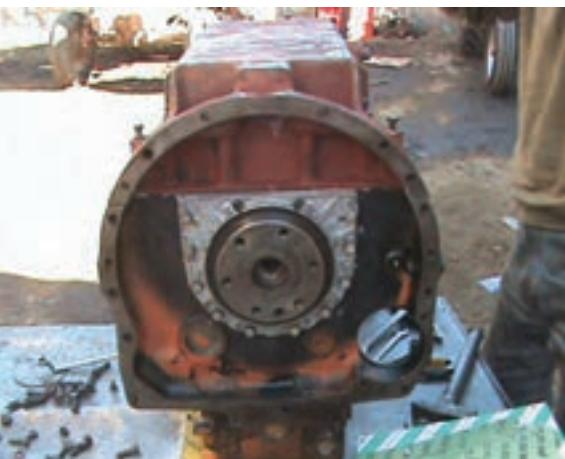
شکل ۱۵۰—۴—انتهای میلنگ بدون چرخ لنگر
