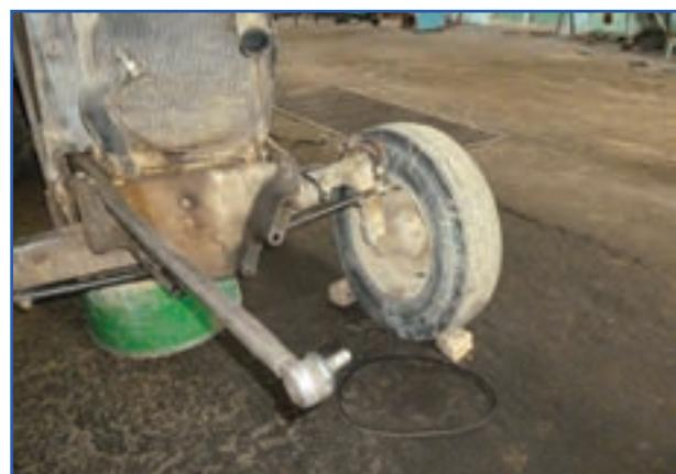
شکل ۳-۲۱- قسمت جلوی تراکتور جدا شده از موتور
