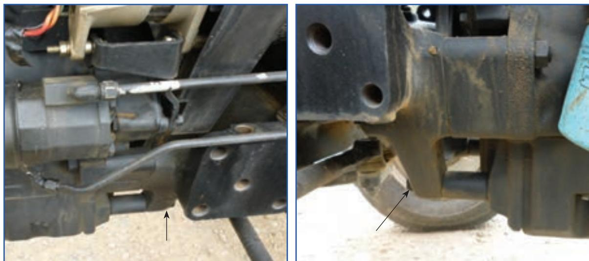
شکل ۱۷-۳ - محل پیچ‌های اتصال موتور به جلوی تراکتور
