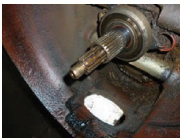
شکل ۱۳-۳- شافت ورودی جعبه‌دنده
