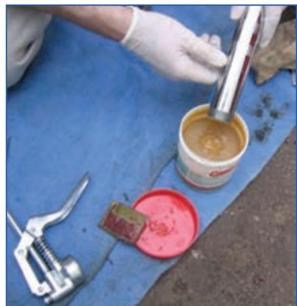
شکل ۴۸-۷- مراحل پر کردن گریس پمپ دستی
