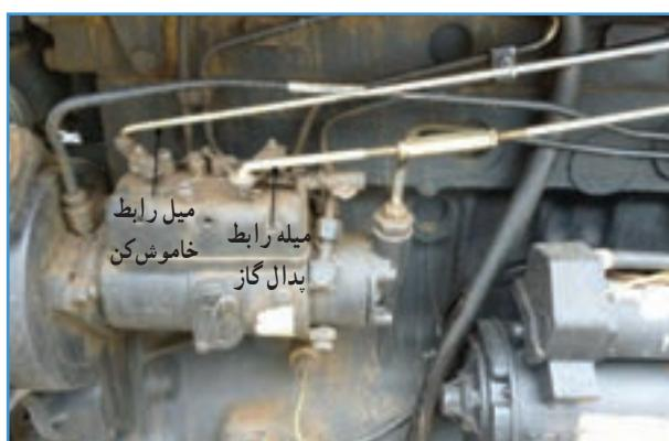
**پمپ انتکتور:** سوخت پس از عبور از صافی به پمپ انتکتور وارد شده سپس تحت فشار زیاد و در زمان مناسب از مسیر لوله‌های فولادی به انتکتورها ارسال می‌گردد.
