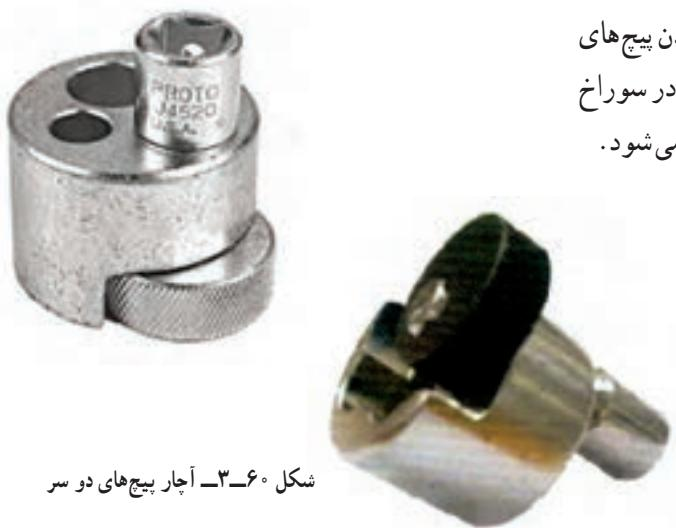
شکل ۳-۶۰—آچار پیچ‌های دو سر دنده
