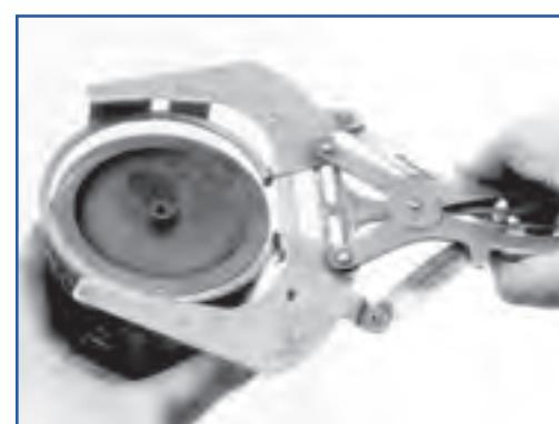
الف) طرز قرار گرفتن رینگ باز کن روی رینگ
