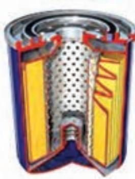
شکل ۷-۱۵- طرز قرار گرفتن لایه کاغذی در صافی
