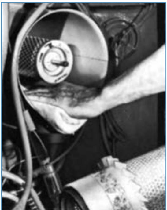
شکل ۱۳-۵- تمیز کردن بدنه صافی با پارچه
