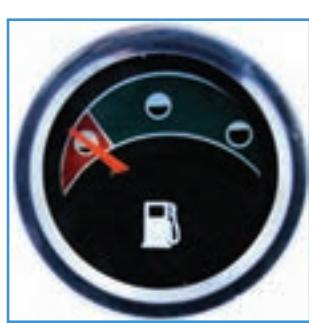
شکل ۷-۹ - درجه نشاندهنده مقدار سوخت در مخزن سوخت
