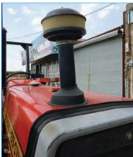
شکل ۲-۲۵ - پیش صافی تراکتور MF285
