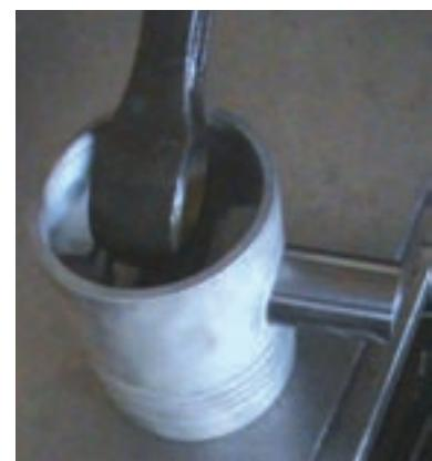
شکل ۱۲۲-۴- اتصال شاتون به پیستون و
