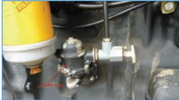
شکل ۲-۲۹—پمپ مقدماتی تراکتور MF285
