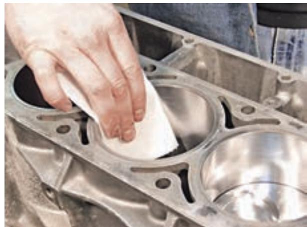
شکل ۴-۲۰۸—تمیز کردن داخل سیلندر
