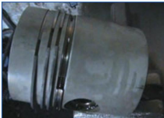
شکل ۱۳۹-۴— ترتیب قرار گرفتن رینگ‌ها روی شیار پیستون
