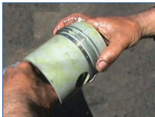
شکل ۱۹۶-۴- تنظیم کردن دهانه رینگ‌ها
