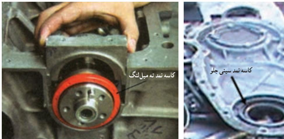
شکل ۳۹-۷- کاسه نمد سر و ته میل لنگ
