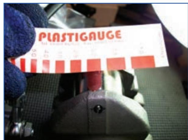
شکل ۱۷۶—۴—اندازه‌گیری دو پهنه پلاستیک گیج شابلون
