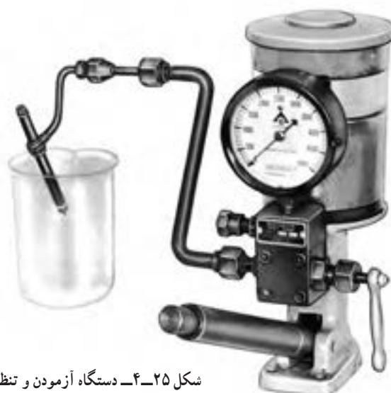
شکل ۲۵-۴- دستگاه آزمودن و تنظیم اتزکتور
