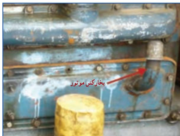
شکل ۷-۲۶—تهویه محفظه کارترا تراکتور U650M
