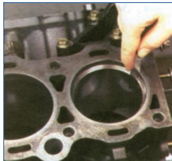
شكل ۱۲۸-۴- طرز اندازه‌گیری دهانه رینگ با فیلر
