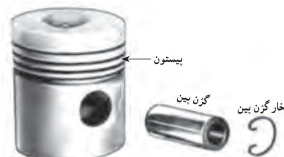
شکل ۲-۳۰—انگشتی و محل نصب آن روی پیستون
