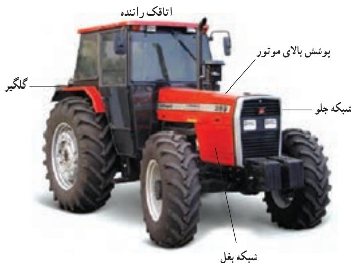
شکل ۲-۲. بدن و پوشش‌های تراکتور مسی فرگوسن (MF399)
