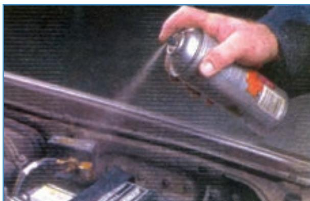
شکل ۱۱-۶- پاشیدن اسپری ضدخوردگی روی بست باتری
