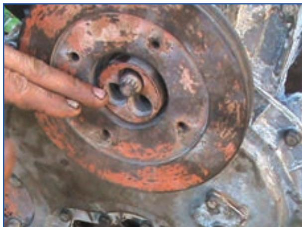
شکل ۵۵-۴- بستن پیچ سر میل لنگ تراکتور
