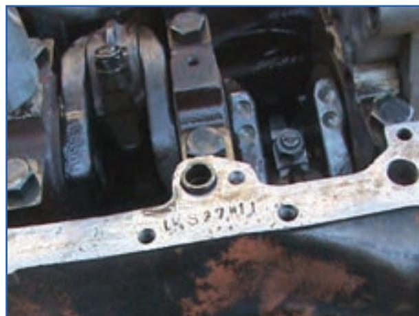
شکل ۴-۸۲— محفظه میل لنگ بدون پمپ روغن
