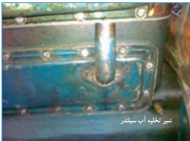
شكل ۳-۳- شیر تخلیه آب سیلندر MF285
