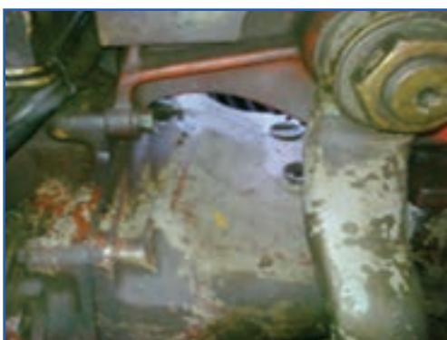
شکل ۳-۹- پیچ‌های اتصال موتور به جعبه‌دنده قسمت بالا
