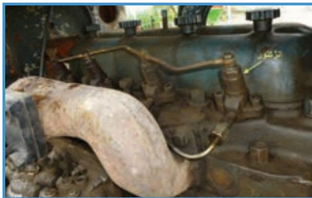
شکل ۲-۳۲ - انژکتورهای تراکتور M650M
