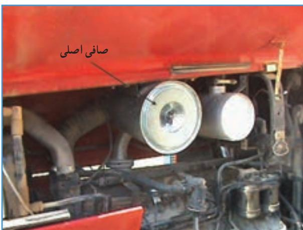
شکل ۶-۵ – محل قرار گرفتن صافی خشک در تراکتور MF399
