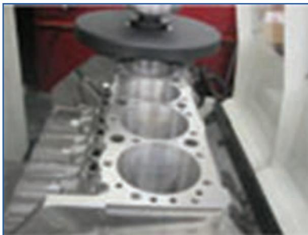
شکل ۴-۳۳— دستگاه کف تراشی بدنه سیلندر
