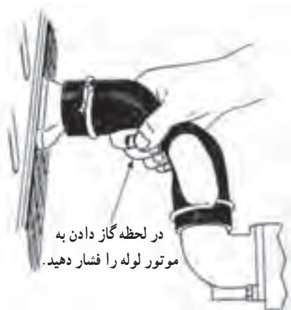
شکل ۲۰-۳-۲۰. نحوه فشار دادن شیلنگ بالای رادیاتور
