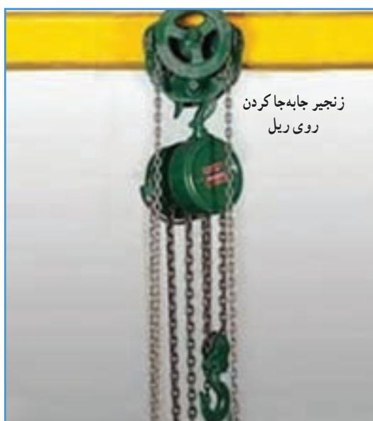
شكل ۲۰-۴-۴. اتصال جرثقیل سقفی به ریل
