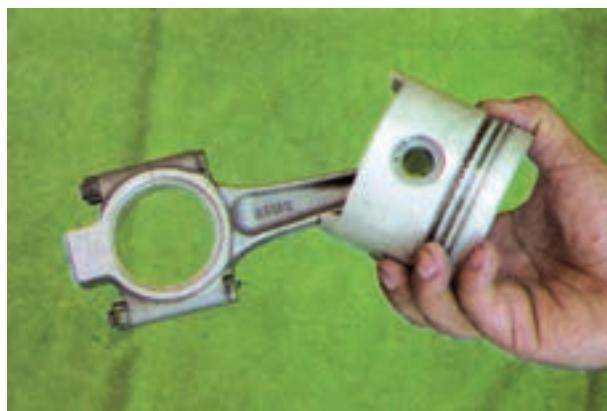
شکل ۱۲۶-۴- طرز آزمایش لقی شاتون روی انگشتی
