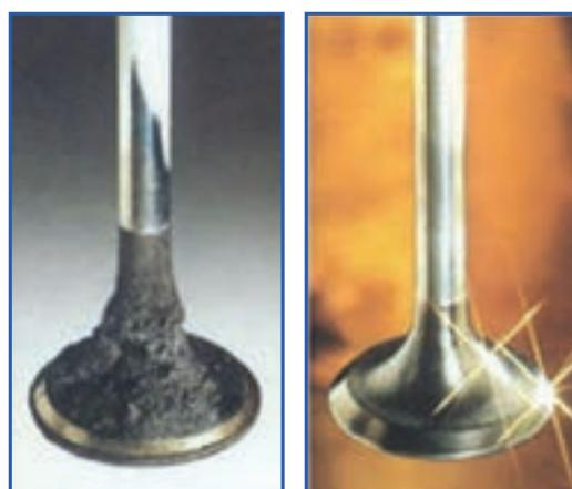
الف) سوپاپ تمیز شده با محلول
