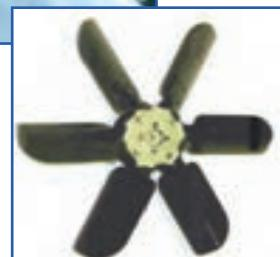
**پروانه:** پروانه بین رادیاتور و موتور قرار گرفته و روی محور پمپ آب نصب می شود. این دو به وسیله سسمه پروانه ای که روی چرخ سسمه (بولی) قرار دارد به چرخ سسمه میل لنگ مرتبط شده و با چرخش میل لنگ پروانه و پمپ آب نیز به چرخش درمی آیند. پروانه هوا را از رادیاتور کشیده و به موتور می زند. در اطراف پروانه بادگیر روی رادیاتور نصب شده که مکش هوا از رادیاتور را متمرکز کرده و از برخورد اجسام با پروانه جلوگیری می کند.
