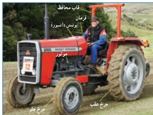
شکل ۱-۲- قطعات ظاهری تراکتور
