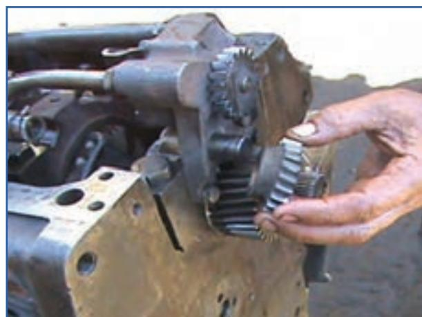
شکل ۴-۸۰— خار چرخ دنده پمپ روغن
