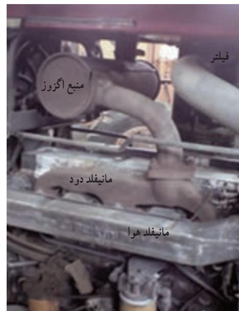
شكل ۵-۲۲- محل مانیفلد دود و هوا در تراکتور MF399
