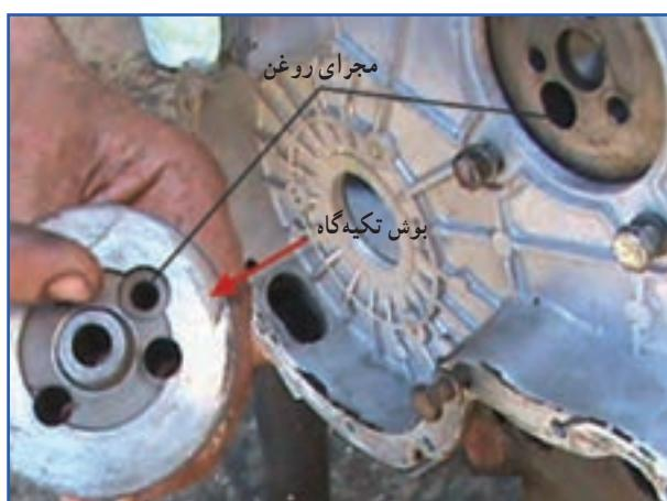
شکل ۴-۶۸ - خارج کردن بوش تکیه گاه چرخ دنده واسط
