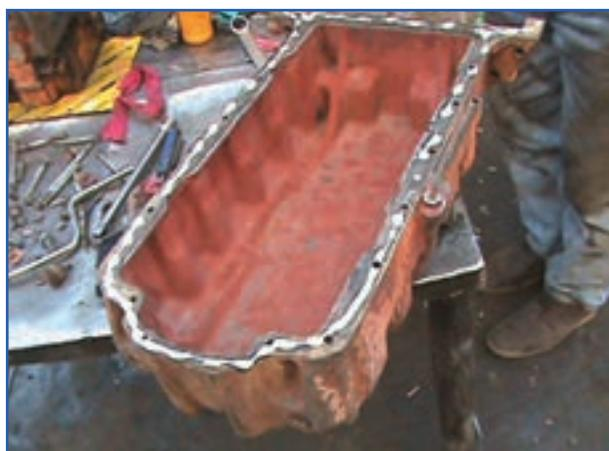
شکل ۷-۲۵—کارترا تراکتور MF285
