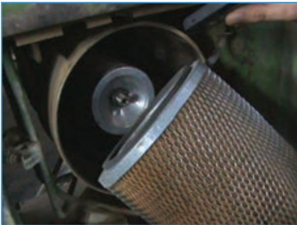
شکل ۵-۵ – صافی خشک و محل قرار گرفتن آن
