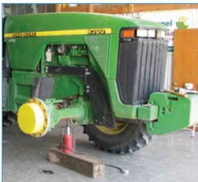
شکل ۱۱-۴- قرار دادن جک رو غنی زیر جسم سنگین
