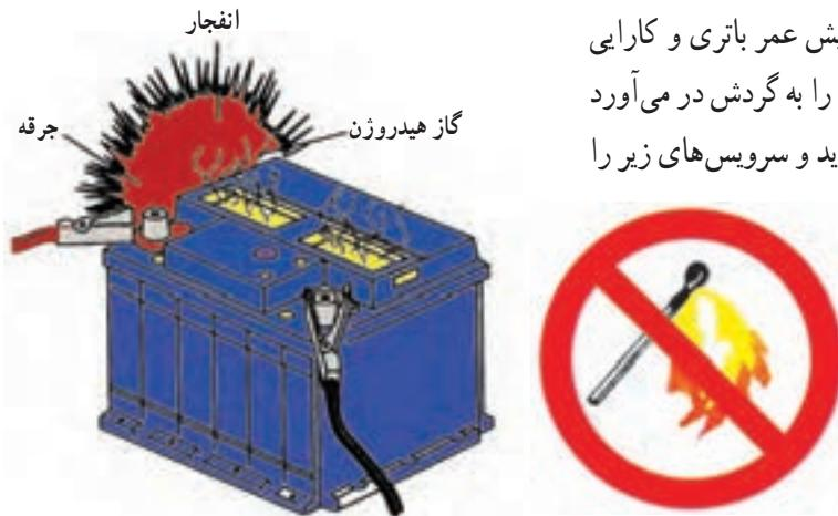
شکل ۲۰-۶— از نزدیک کردن شعله به باتری خودداری کنید.
