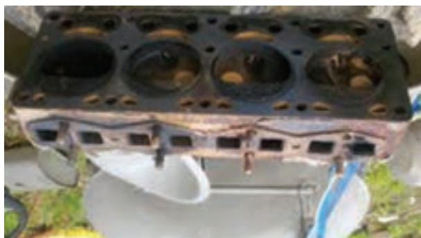
شکل ۴-۲۰۹—رسوبات کرین سطح سرسیلندر
