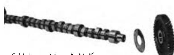
شکل ۲-۱۱ - چرخ‌دنده سر میل بادامک
