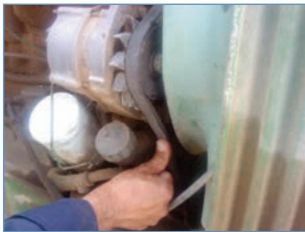
شکل ۳۶-۶- فشار دادن تسمه با شست
