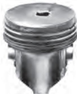
شكل ۱۰۲-۴- سوراخ شدن سر پیستون
