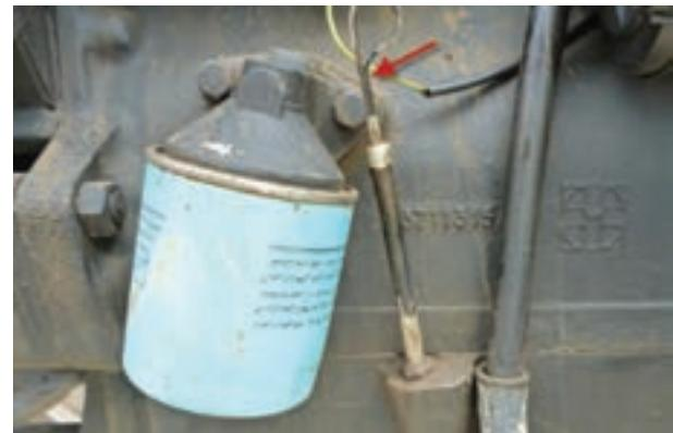
شکل ۷-۳۰- میله سنجش سطح روغن تراکتور MF285
