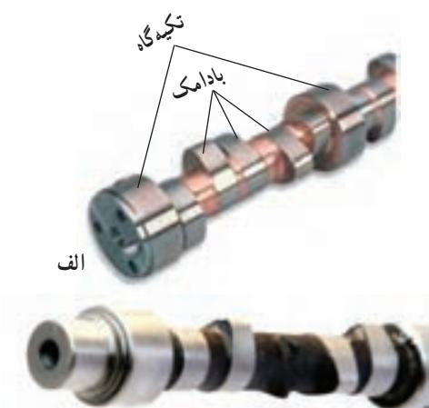
شکل ۲-۹ - میل بادامک
