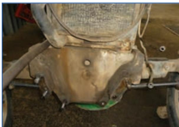
شکل ۳-۲۰- پیچ‌های قسمت جلوی تراکتور که باید به موتور متصل شود.
