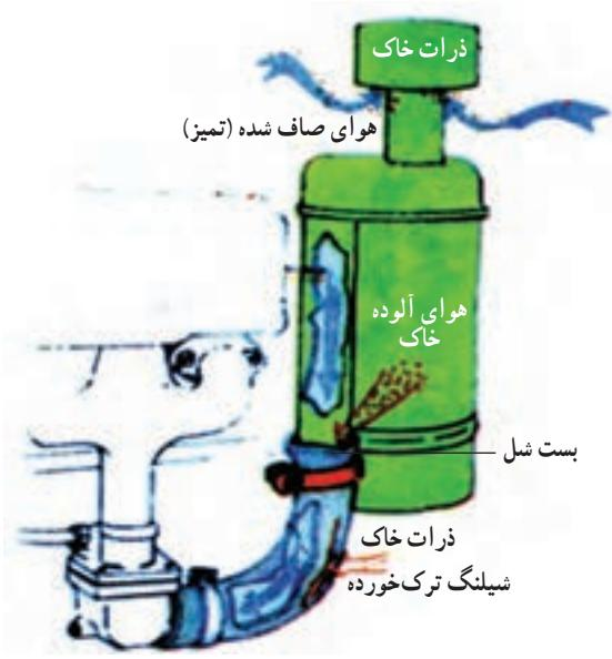
شکل ۱۹-۵- محل بریدگی و سوراخ شدگی در شیلنگ‌ها
