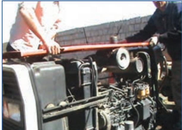
شکل ۱-۴- برداشتن کاپوت از روی موتور
