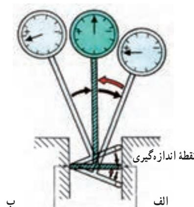
شكل ۱۴۷—۴— اندازه‌گیری قطر داخلی سیلندر با ساعت اندازه‌گیر
