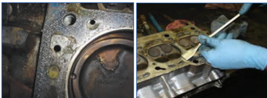
ب) واشر سرسیلندر چسبیده سرسیلندر
