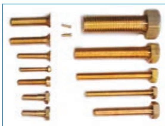
شکل ۳-۷ - انواع پیچ با دنده ظریف و درشت
