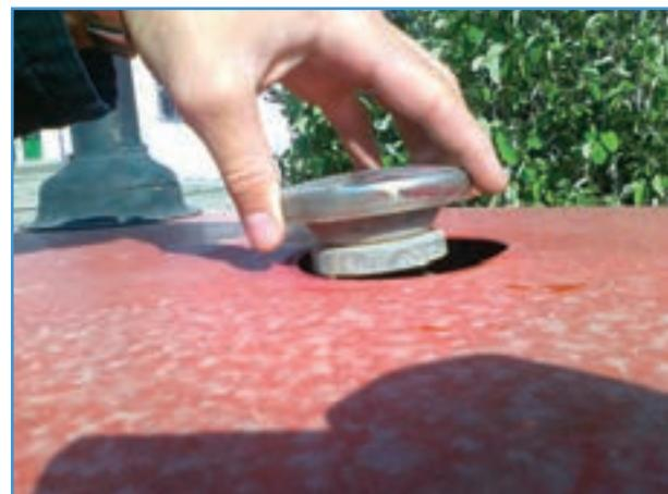
شكل ۳-۴- باز کردن در رادیاتور تراکتور MF285
