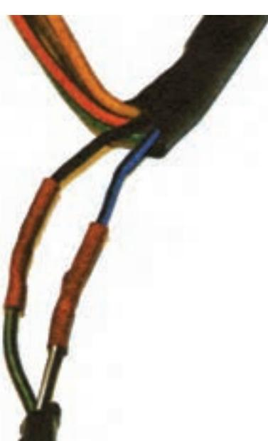
شکل ۶-۶۷— اتصال کامل سیم ها با روکش تیوب عایق
