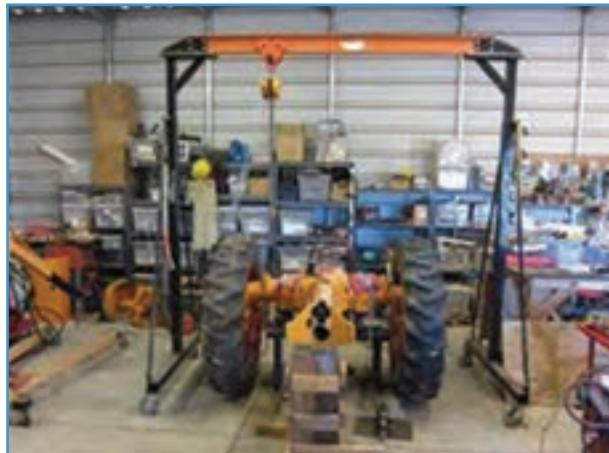
شکل ۴-۲۴—کاربرد جرثقیل دروازه‌ای متحرک
