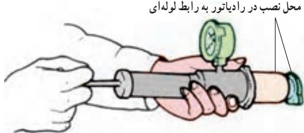
شکل ۳-۱۶ - آزمون سوپاپ فشار در رادیاتور
