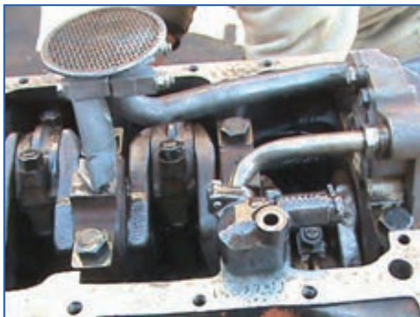
شکل ۴-۸۱— باز کردن لوله خروجی پمپ و سویاپ فشار
