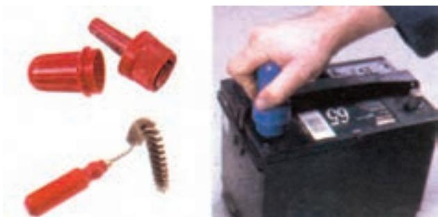
شکل ۲۳-۶- تمیز کردن قطب‌های باتری با ابزار مخصوص
