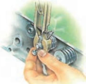
شکل ۱۷-۴- نحوه برداشتن دو پارچه از شیار سوپاپ
