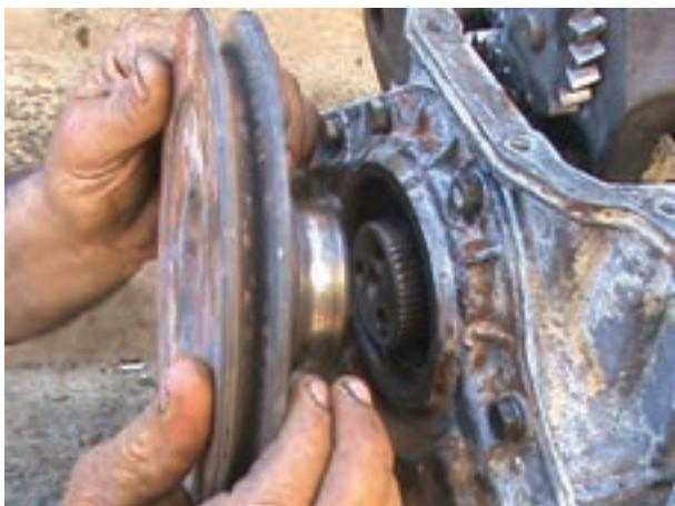
شکل ۵۷-۴- خارج کردن پولی میل لنگ
