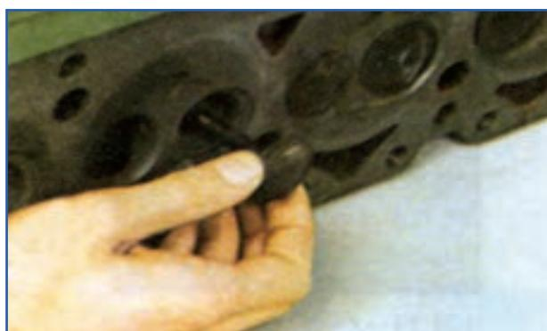
شکل ۲۳-۴-۴- نحوه خارج کردن سوپاپ‌ها
