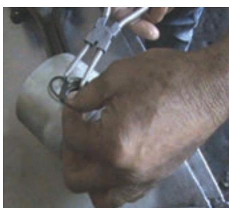
شکل ۱۲۵-۴- طرز جازدن خار انگشتی
