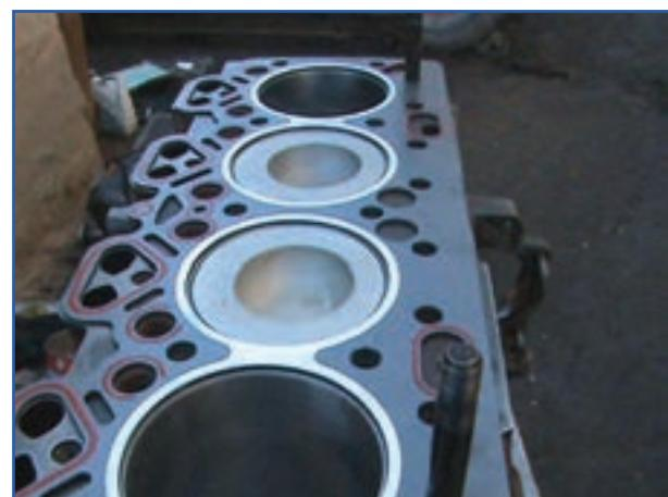
شکل ۵۲-۴- قرار دادن و اشر سرسیلندر روی بدنه سیلندر
