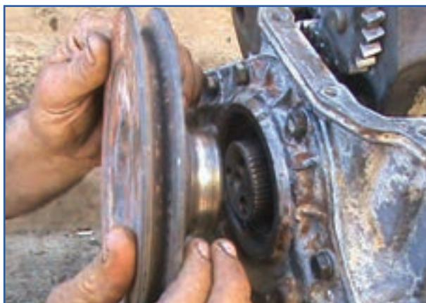
شکل ۴۶-۷- جازدن چرخ تسمه سر میل لنگ
