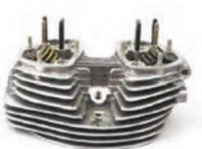
شکل ۲-۳ – سرسیلندر موtor هوا خنک
