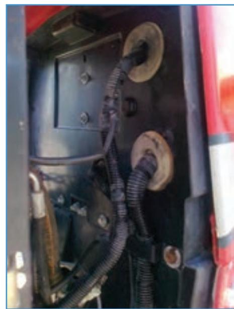
شکل ۵۷— چند نمونه از سیم‌کشی که سیم‌ها در آنها با نظم کنار هم قرار گرفته‌اند.
