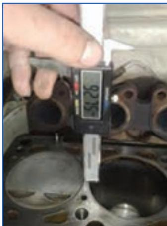
شکل ۵-۲۰۵- کنترل ارتفاع پیستون
