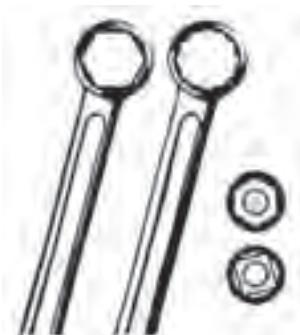
شکل ۳۰-۳۰ - آچار رینگی با سر شش و دوازده گوش
