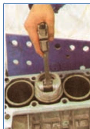
شکل ۱۲۷-۴- طرز قرار دادن رینگ داخل سیلندر
