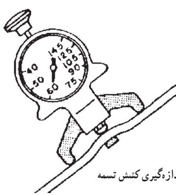
شکل ۳-۲۷ - ابزار مخصوص اندازه گیری کشش تسمه
