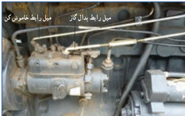
شکل ۶-۳-۳- میله رابط پدال گاز و میله رابط خاموش کن
