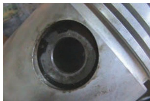
شکل ۱۲۵-۴- جا افتادن خار انگشتی در شیار پیستون
