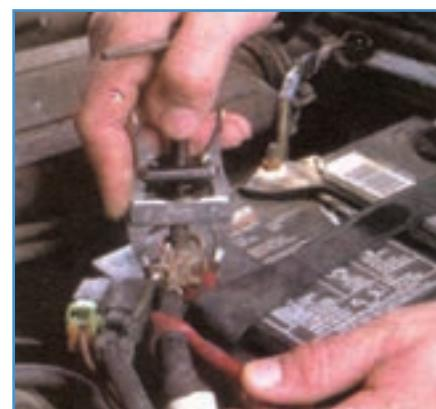
شکل ۸-۶- باز کردن بست مثبت باتری
