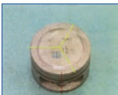
$$\text{زاویه دهانه رینگ کمپرسی} = \frac{\text{تعداد رینگ کمپرسی}}{360^\circ}$$
