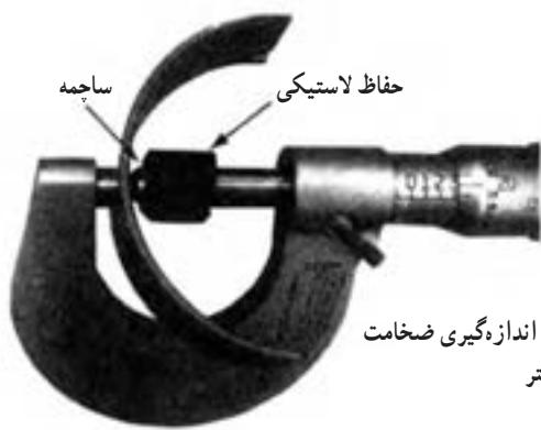
شکل ۱۷۰-۴- اندازه‌گیری ضخامت
