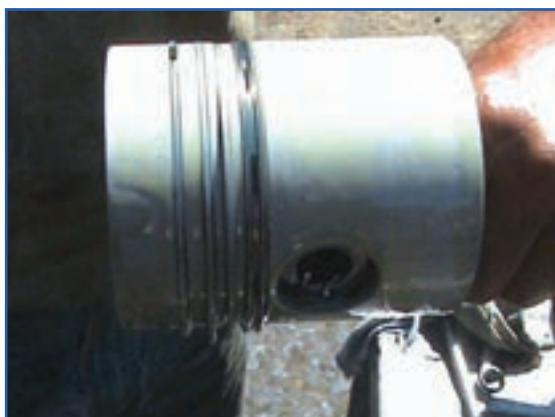
شکل ۱۴۰-۴— روغن کاری همه رینگ‌ها و پیستون
