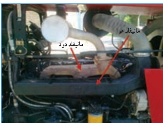
شکل ۲-۲۷ - مانیفلد هوا و دود تراکتور MF399
