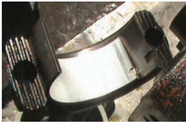
شکل ۴-۸۶— جازدن زبانه یاتاقان در شیار کپه یاتاقان
