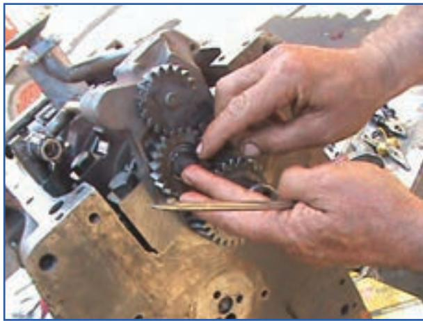
شکل ۴-۷۹—خارج کردن خار چرخ دنده پمپ روغن
