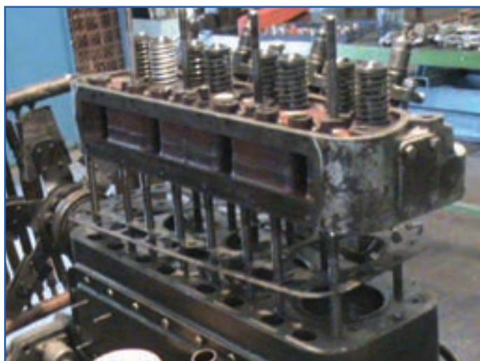
شكل ۵-۲- وضعیت قرار گرفتن واشر سرسیلندر
