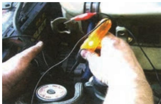
شکل ۷۷-۶- اتصال لامپ آزمایش به مدار
