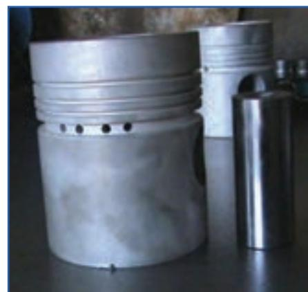
شكل ۴-۱۰۷- پیستون و انگشتی نو
