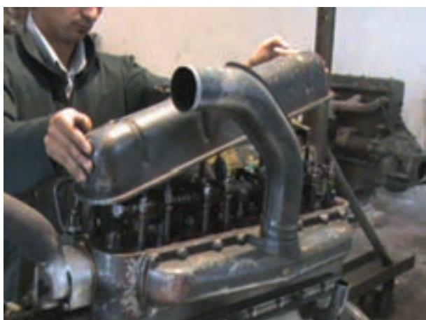
شکل ۶-۷- برداشتن درپوش سوپاپ
