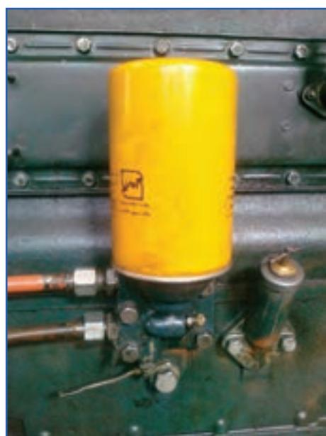
شکل ۷-۱۸- صافی روغن تراکتور U650M
