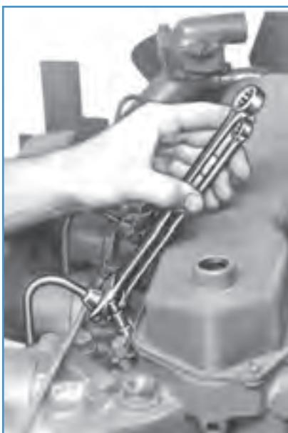
شکل ۴-۲۲- باز کردن لوله های فشارقوی انژکتورها
