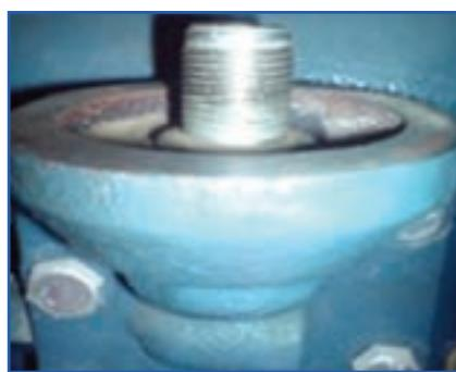
شکل ۷-۱۷- پایه صافی روغن تراکتور U650M
