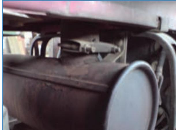
الف) بست اگزووز در تراکتور MF399
