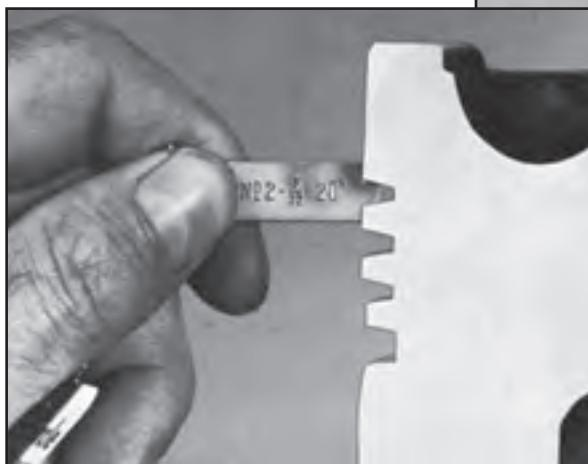
شکل ۴-۹۴- طرز تراش شیار رینگ
