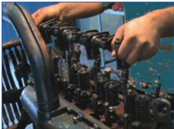
شکل ۴-۹. برداشتن محور اسپک و اسپک‌های تراکتور U650
