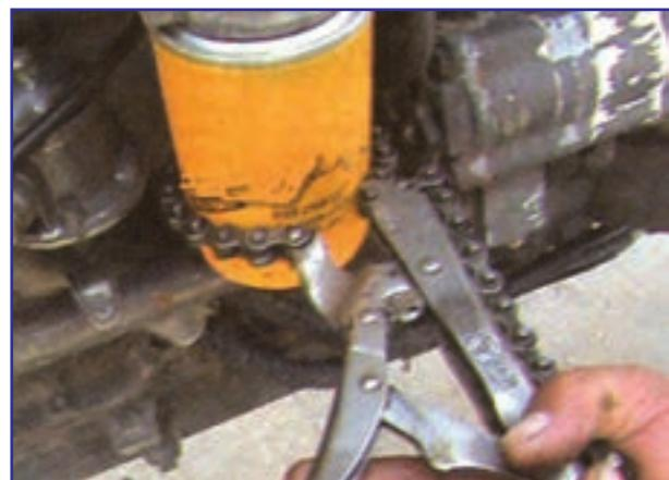
شکل ۷-۱۶- باز کردن صافی روغن با آچار مخصوص
