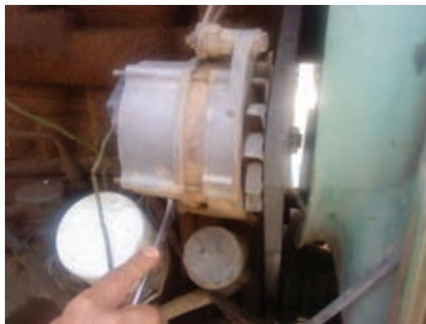
شکل ۳۹-۶- سفت کردن پیج تنظیم آلترناتور
