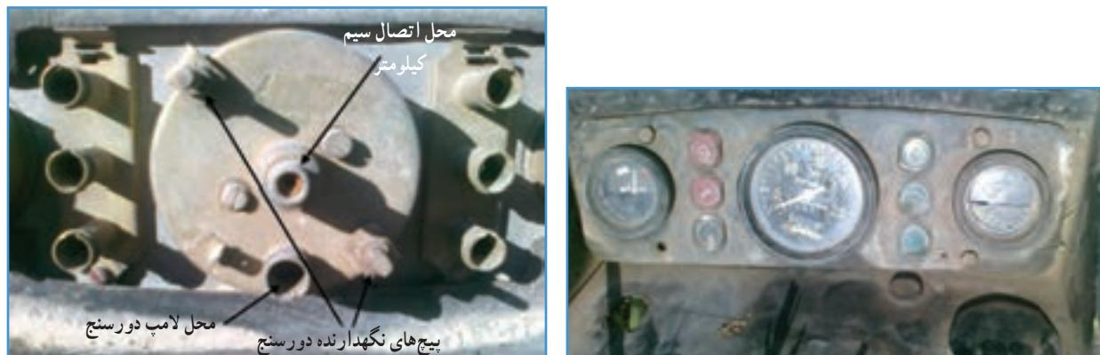
شکل ۸۲-۶—جلو داشبورد باز شده تراکتور M650U از قسمت روی داشبورد تراکتور M650U
