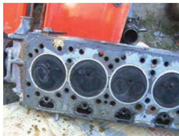
شکل ۱۵-۴- طرز قرار دادن سرسیلندر روی سطح صاف
