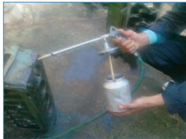
شکل ۳-۱— باز کردن مخزن پیستوله شستشو
