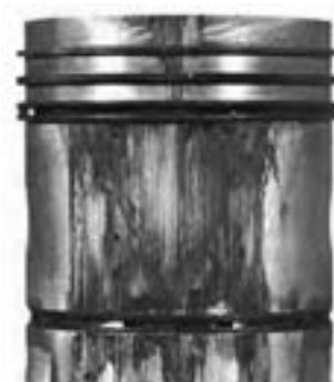
الف) خط و خش روی پیستون
