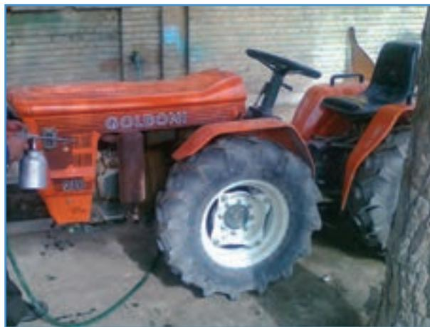
شکل ۱-۴— شستشوی موتور تراکتور با پیستوله شستشو
