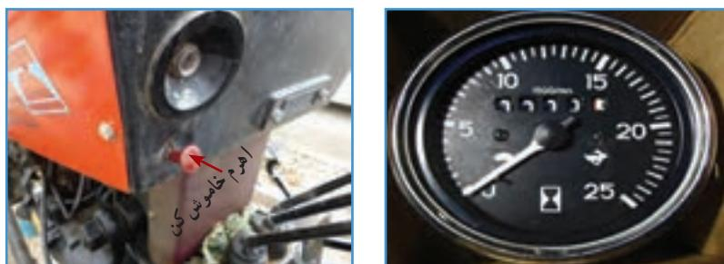
شكل ۲-۱۳- اهرم خاموش کن تراکتور MF286
