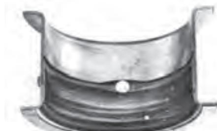
شکل ۱۶۵-۴- خط به دلیل نفوذ ذرات ریز و درشت بین میل لنگ یاتاقان
