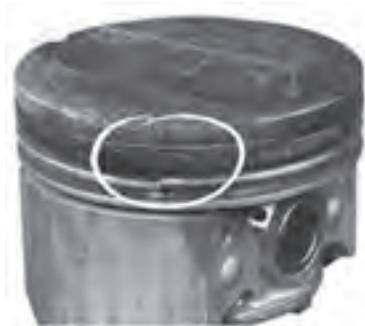
شكل ۹۹-۴- شکستن رینگ و تخریب جای رینگ
