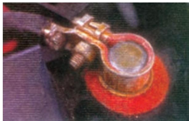
شکل ۱۱-۶- مالیدن گریس به بست باتری
