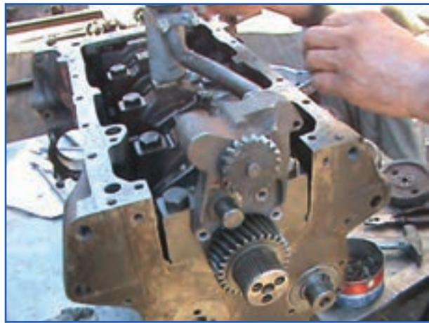
شکل ۴-۷۸— محل بیج های پمپ روغن
