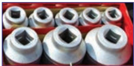
شکل ۳-۳۹— انواع شکاف چهارگوش(درایوبکس) آچار بکس
