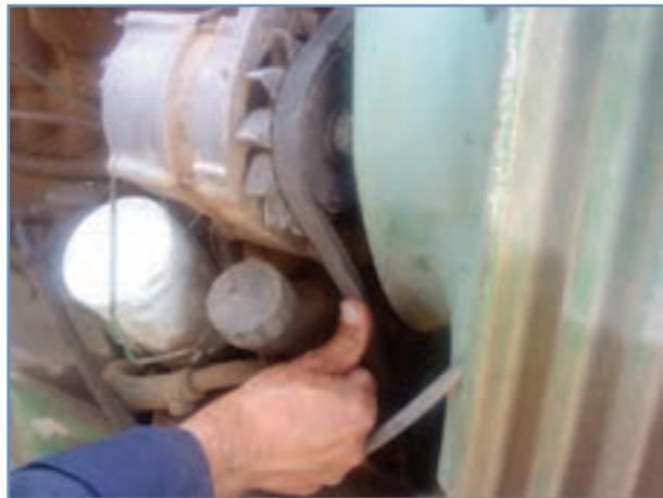
شکل ۳-۲۸ - اندازه‌گیری کشش تسمه با فشار انگشت
