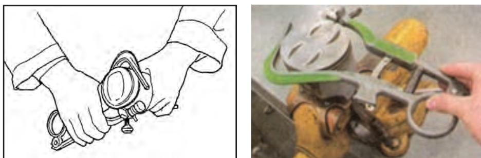
(ب) کاربرد ابزار تمیزکننده شیار رینگ‌ها
