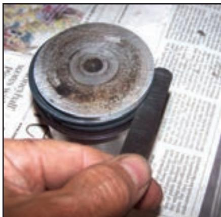
شکل ۴-۹۳- طرز اندازه‌گیری لقی رینگ در شیار رینگ‌ها با فیلر
