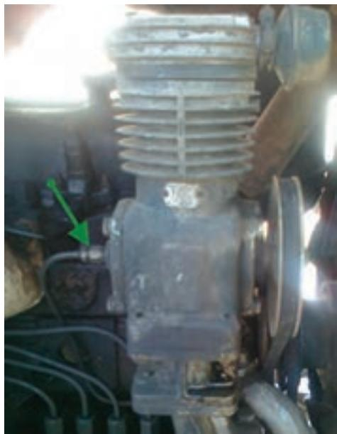
شکل ۸-۵- لوله روغن کاری کمپرسور در تراکتور U650
