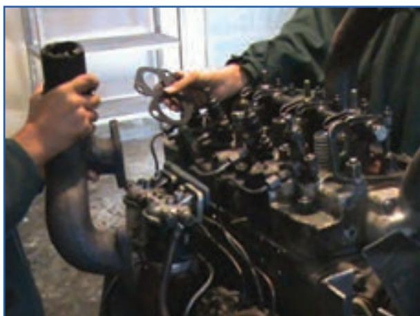
شکل ۴-۴- باز کردن مانیفولد هوا
