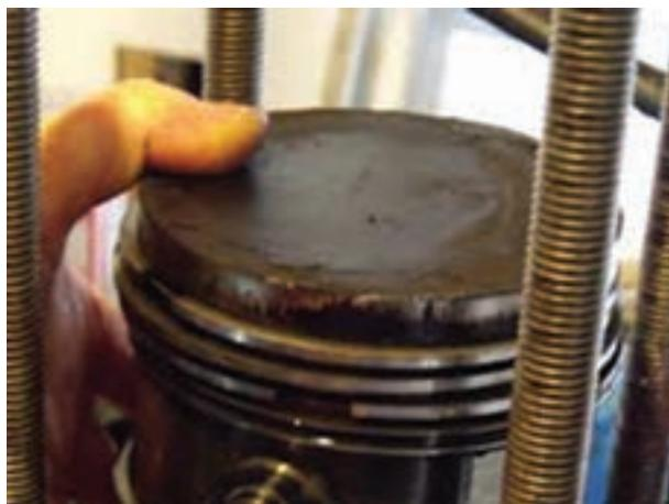
شکل ۴-۲۰۷—رسوبات کرین روی سطح پیستون
