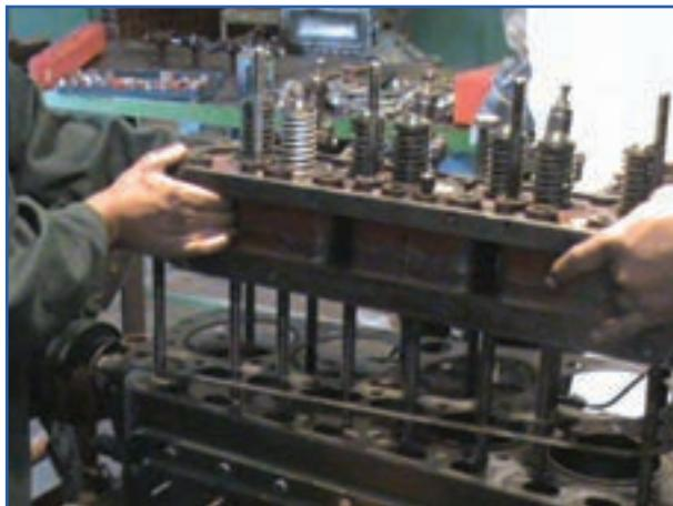
شکل ۱۴-۴- بلند کردن سرسیلندر از روی بدنه سیلندر
