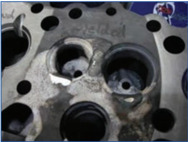
شکل ۲۶-۴- ترمیم ترک سرسیلندر با جوشکاری
