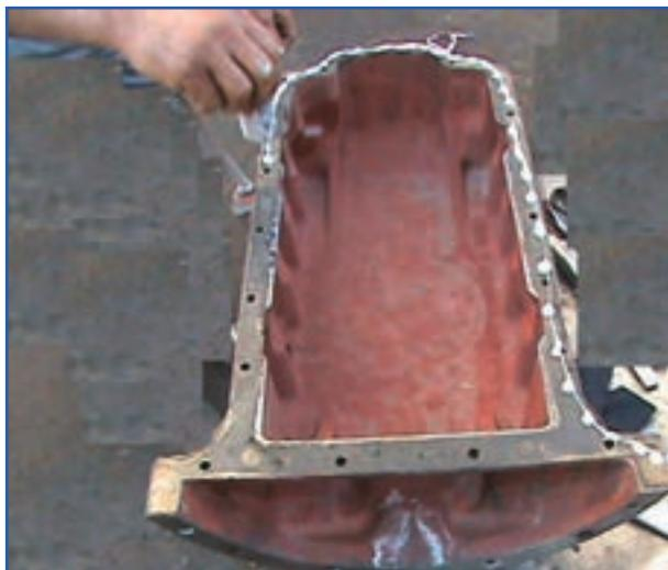
شکل ۷-۳۲- چسب زدن به محل قرارگیری واشر کارترا
