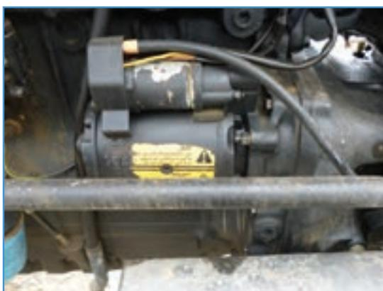
شکل ۲-۴۵ - استارت تراکتور MF285
