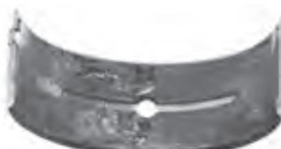
شکل ۱۶۷-۴- نقاط ذوب شده روی یاتاقان
