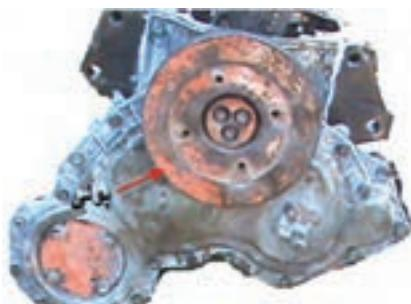
شکل ۴-۶۴ - پولی نصب شده روی میل لنگ
