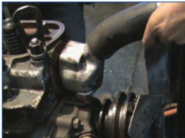
الف) باز کردن محفظه ترموستات تراکتور U650
