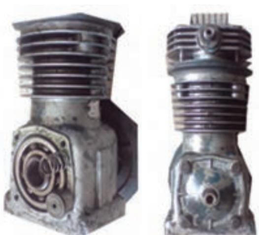
شکل ۸-۴ - کمپرسور کامل با بدنه برهدار برای خنک شدن
