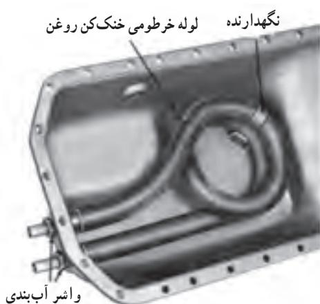
شکل ۷-۳۳- لوله مارپیچ آب در کارترا تراکتور جاندیر
