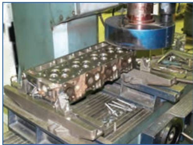
شکل ۴-۳۲— دستگاه کف تراشی سرسیلندر
