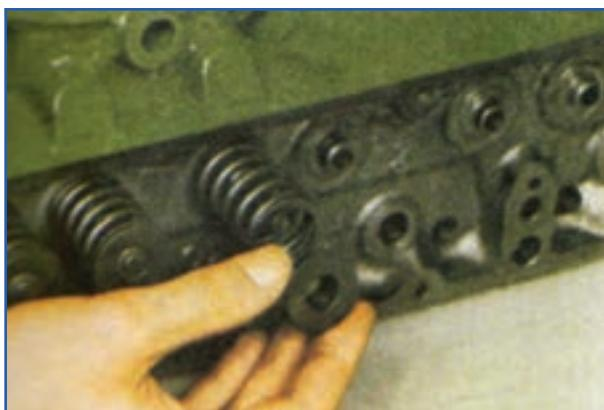
شکل ۱۹-۴- نحوه برداشتن بشقابک فنر سوپاپ
