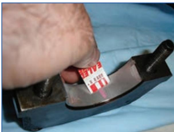
شکل ۱۷۷—۴—وضعیت پلاستیک گیج قبل و بعد از آزمایش لقی میل لنگ
