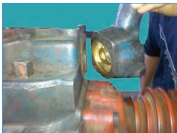
شكل ۲۱-۳- باز برداشتن دربوش ترموموستات بعد باز کردن پیچ‌های آن در تراکتور U650M
