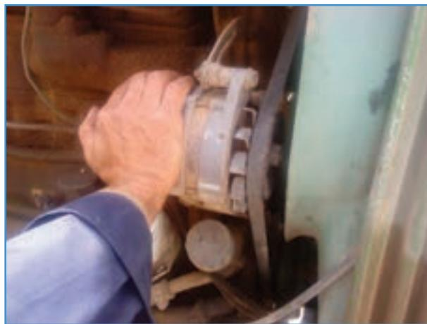
شکل ۶-۳۰— فشار دادن آلتريناتور به عقب
