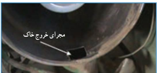
شکل ۱۱-۵- محل خاکدان در تراکتور جاندیر
