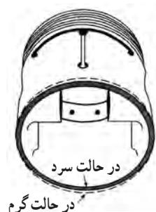
شکل ۲-۱۹ - وضعیت پیستون در حالت گرم و سرد
