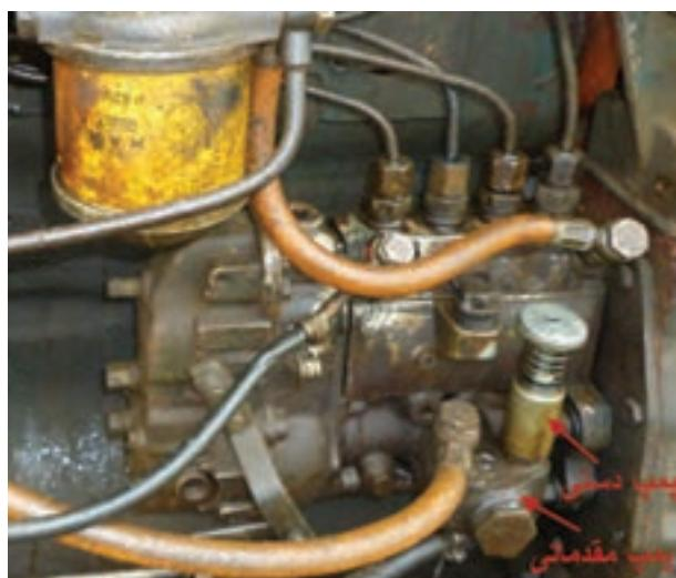
شکل ۸-۴- محل قرار گرفتن پمپ دستی روی پمپ انترکتور
