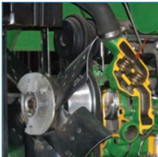
شکل ۳-۲۴ - طرز صحیح قرار گرفتن ترموموستات
