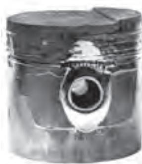
شكل ۱۰۳-۴- سایش غیریکنواخت پیستون
