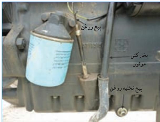
شكل ۷-۲۷- پیچ تخلیه روغن کارتر MF285
