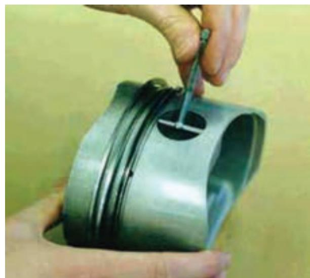
شکل ۱۱۷-۴- اندازه‌گیری سوراخ انگشتی روی پیستون
