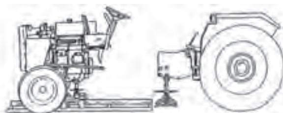
شکل ۱۲-۳- با حرکت جک روی ریل موتور از جعبه‌دنده جدا می‌شود.
