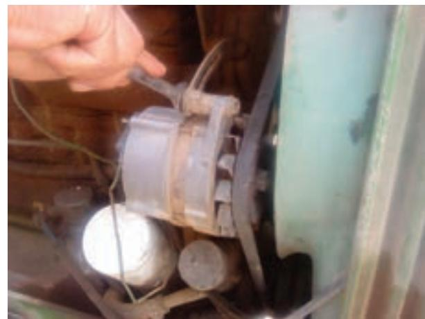
شکل ۳۸-۶- سفت کردن پیج تنظیم آلترناتور
