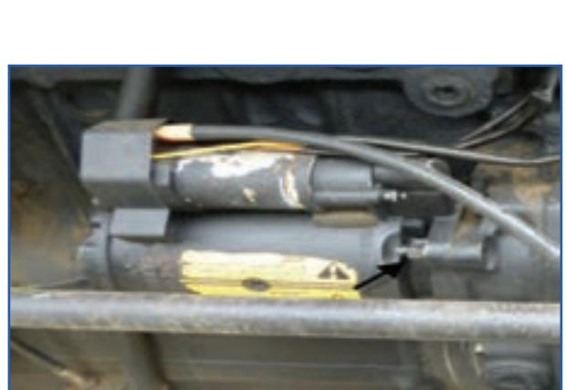
شکل ۶-۳-۸- پیچ های نگهدارنده استارتر تراکتور MF285
