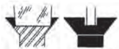
شکل ۷۱-۳- طرز قرار گرفتن لبه پیچ گوشته در شیار پیچ
