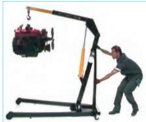
شکل ۱۸-۴—کاربرد از جرثقیل متحرک دستی
