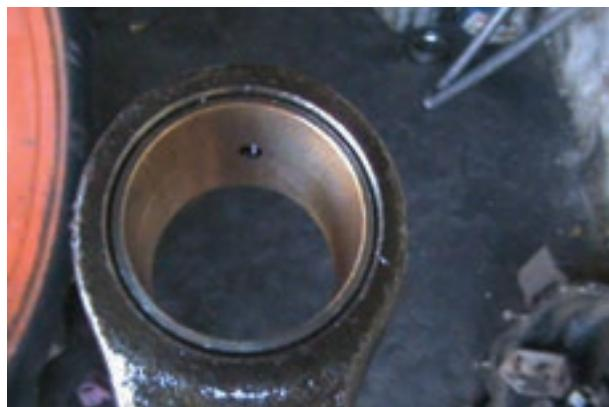
شکل ۱۲۰-۴- قرار گرفتن سوراخ بوش مقابل سوراخ شاتون
