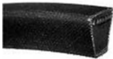
شکل ۳-۲۵ - مقطع تسمه پروانه
