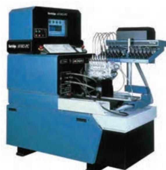
شکل ۲۴-۴- دستگاه آزمودن و تنظیم پمپ اتزکتور
