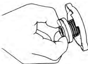
شکل ۳-۱۷ - آزمودن سوپاپ مکش در رادیاتور
