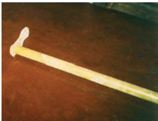
شکل ۲۶-۱ پایه کج شده بلبرینگ انگشتی
