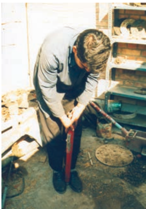
شکل ۳۸-۱- آزمایش کمک‌فنر
