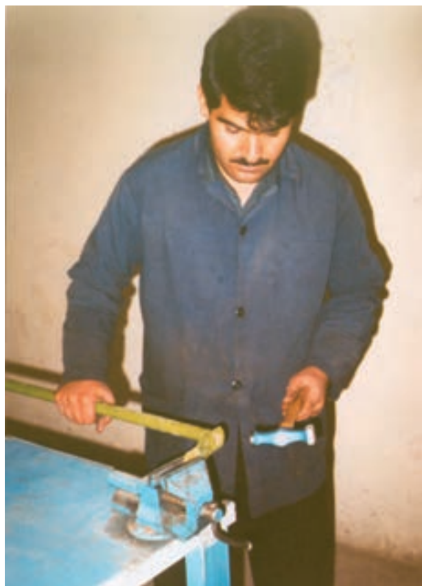
شکل ۲۸-۱- حین صاف کردن پایه بلبرینگ‌ها یا چکشی
