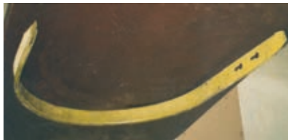
شکل ۳۲-۱- طوقه شکسته و کج شده
