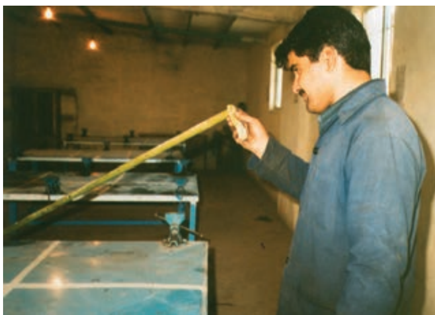
شکل ۲۳-۱- فردی در حال آزمایش کجی محور انگشتی‌ها
