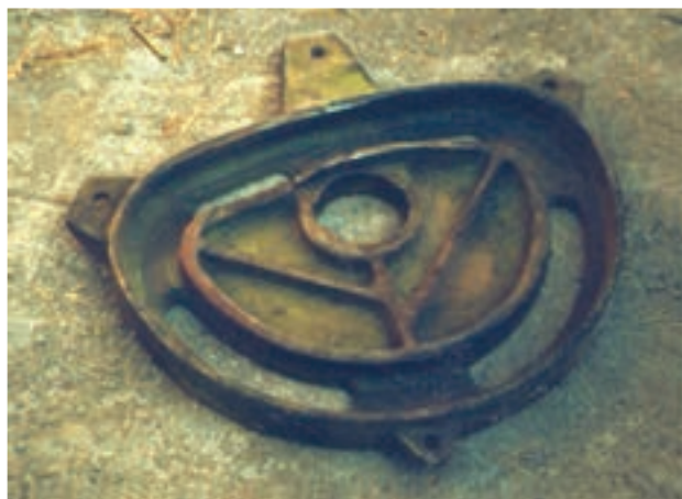
شکل ۲۷-۱- محفظه ( بادامک راه) ساییده شده
