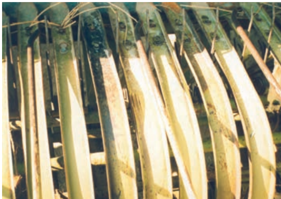
شکل ۱۹-۱- ساییده شدن انگشتی‌ها به طوقه‌ها
