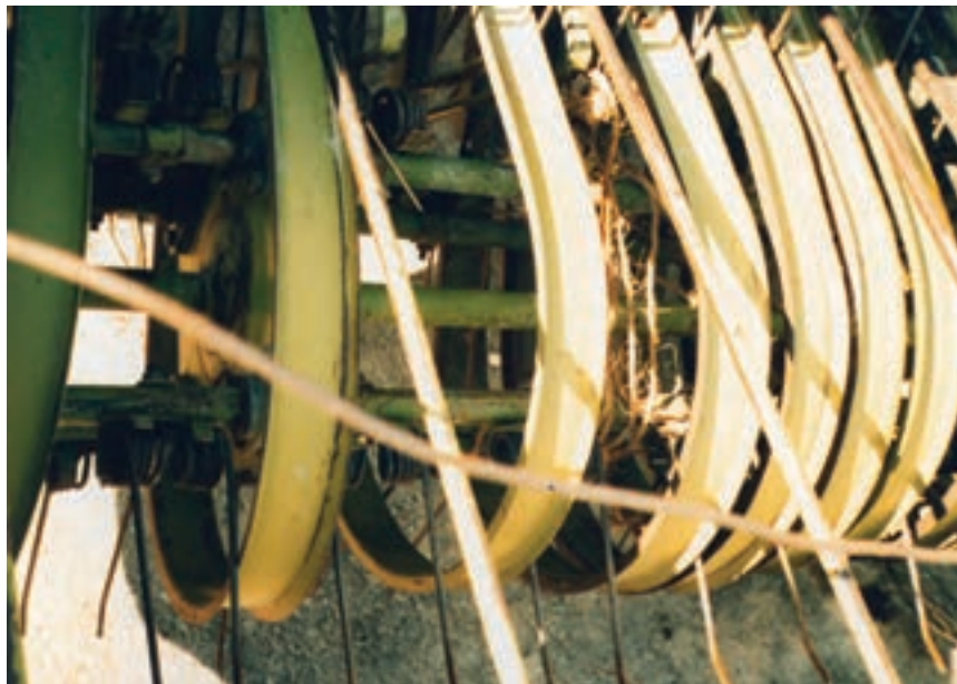
شکل ۲۹-۱- محور انگشتی کج شده
