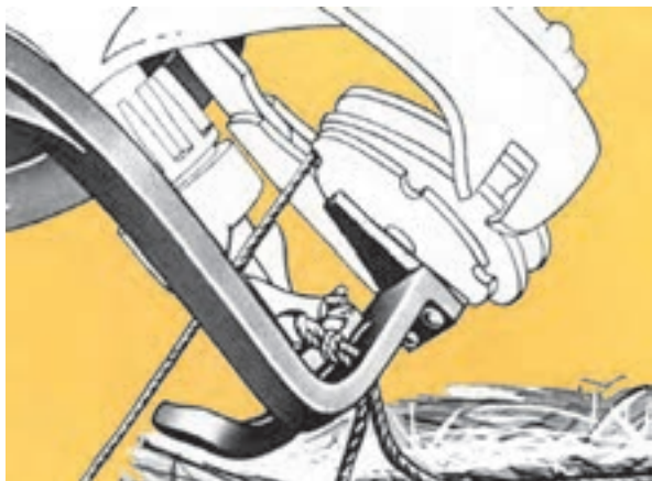
شکل ۶-۳- گرّه تشکیل شده، بیرون می‌افتد.
