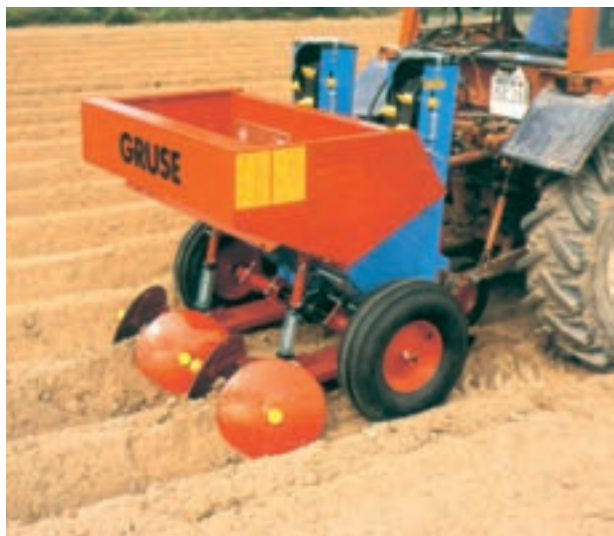
شکل ۲-۵۵- غده کار سوار
