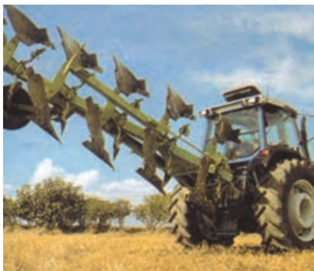
شکل ۲-۱- گاواهن سوار در وضعیت حمل و نقل
