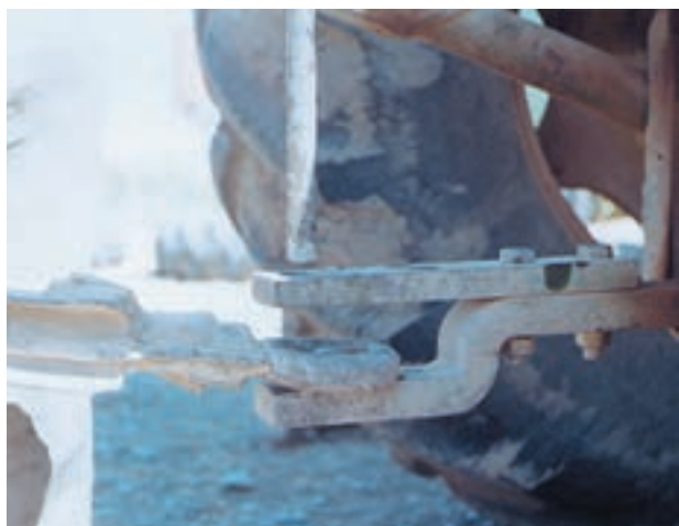
شکل ۳۶-۱ باز کردن پی نورد از تراکتور
