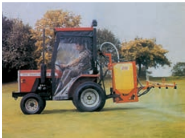
شکل ۲-۲- سمپاش سوار در وضعیت کار
