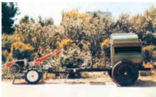
شکل ۱-۵۳- خرمنکوب کششی متصل به تراکتور دوجرخ
