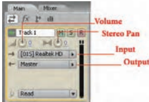
شکل ۱۰-۱۱ کنترل های ورودی و خروجی
