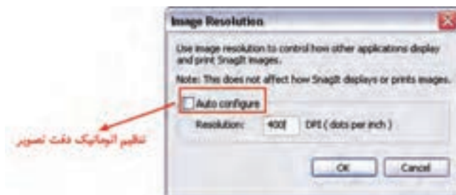
شکل ۲-۲۲ تنظیم دقت تصویر
