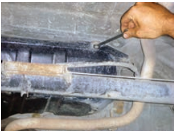
شکل ۱-۲۵ باز کردن پیچهای دور باک
