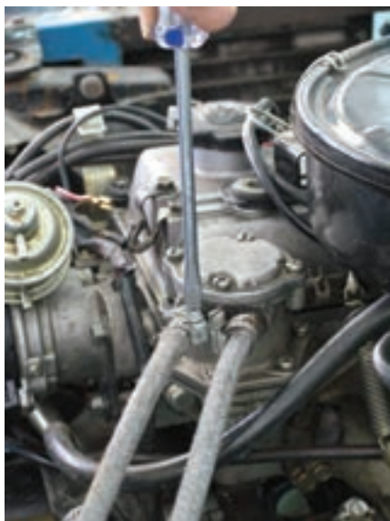
شکل ۱-۳۲ اتصال لوله سوخت به پمپ
