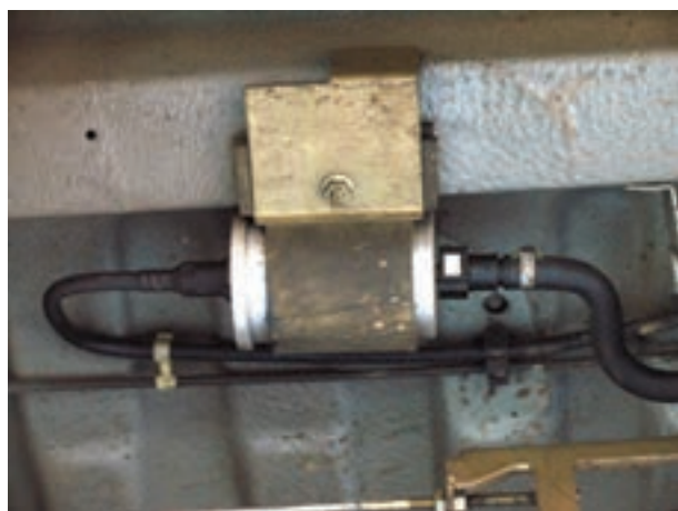
شکل ۱-۴۷ بست‌های دوطرف فیلتر سوخت
