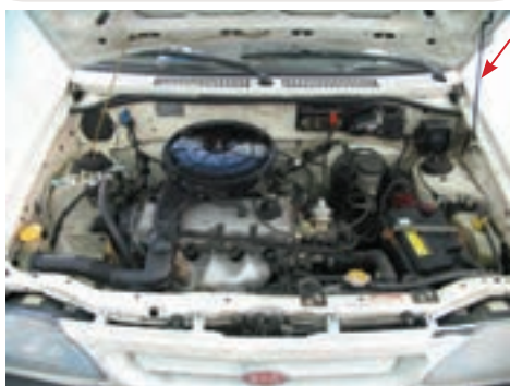
شکل ۱۱۹- ۱ نصب صحیح اهرم نگه‌دارنده درپوش موتور خودرو
