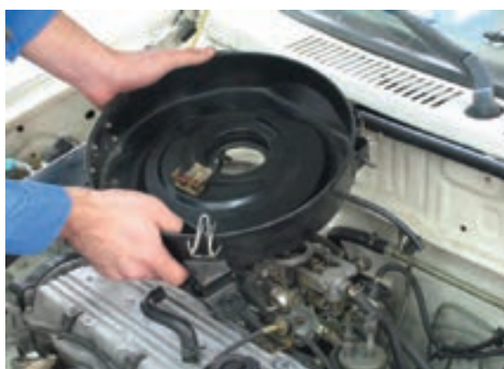
شکل ۱۰۰-۱ پیاده کردن مجموعه هواکش
