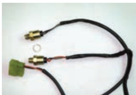
شکل ۱-۹۱ اجزای الکتریکی در یک نوع کاربراتور
