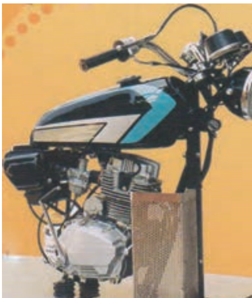
شکل ۱-۳۵ مدار سوخت‌رسانی موتور سیکلت
