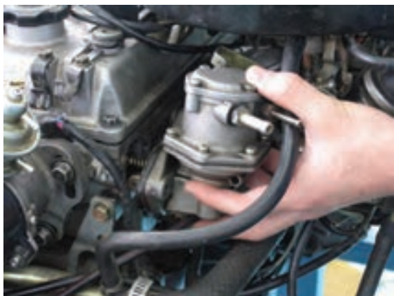
شکل ۱-۴۴ الف: نصب پمپ
