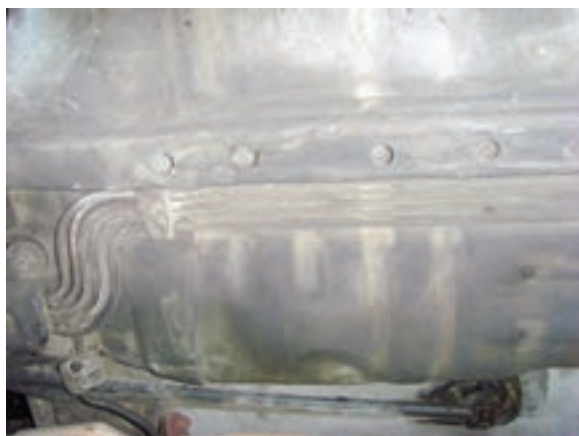
شکل ۱-۳۳ لوله سوخت از مخزن تا پمپ
